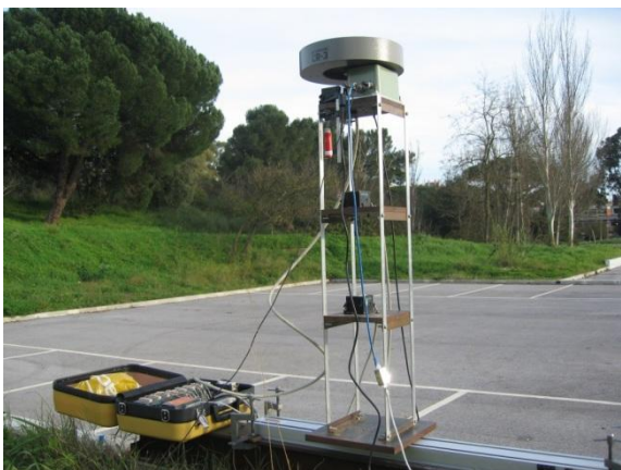
Figura 1. Estrutura constituída por um edifício de 3 pisos a deslizar sobre o movimentador linear. Esta estrutura estava instrumentada com uma antena GNSS da Topcon, com um acelerómetro da Nanometrics triaxial e 3 acelerómetros da Kinematics uniaxiais.
