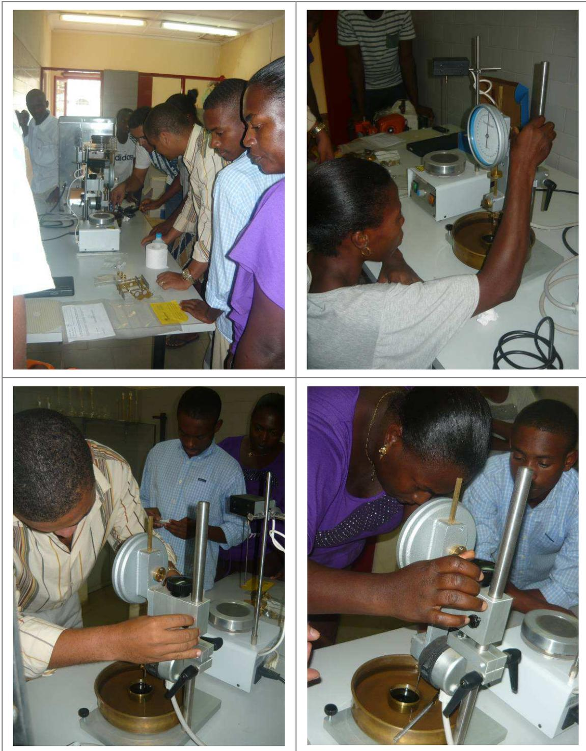
**Figura 3 – Aula prática sobre o ensaio para a determinação da penetração de um betume de pavimentação**
