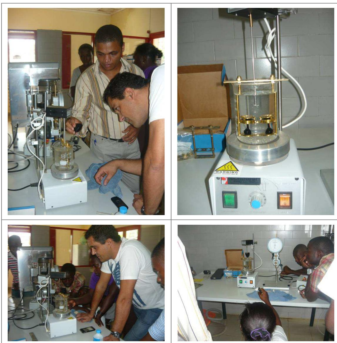
**Figura 2 – Aula prática sobre o ensaio para a determinação da temperatura de amolecimento pelo método de anel e bola de um betume de pavimentação**
