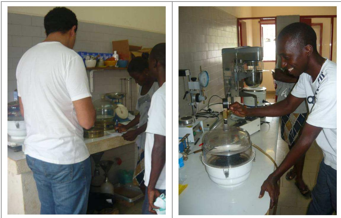
**Figura 5 – Aula prática sobre o ensaio para a determinação da baridade máxima teórica de uma mistura betuminosa**
