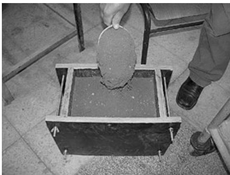
Figura 3: Execução dos provetes de taipa: à esquerda, molde e maço e, à direita, execução do provete através de compactação com o auxílio do maço Fonte: Maria Idália Gomes
