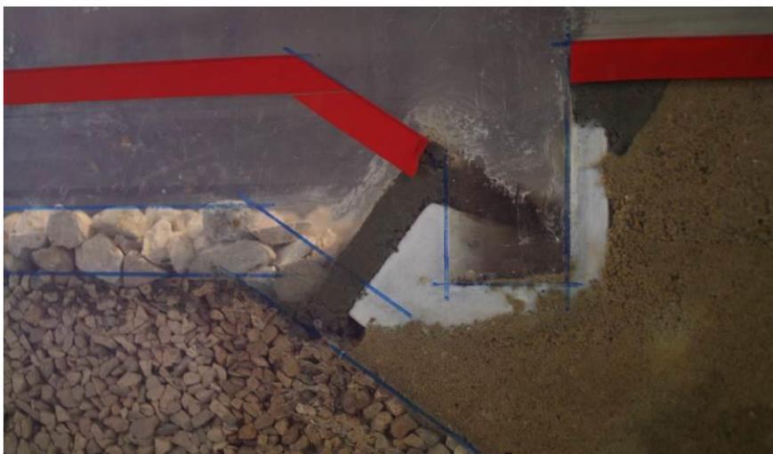
Figura 3-12 – Aspeto do remate superior dos filtros da estrutura
