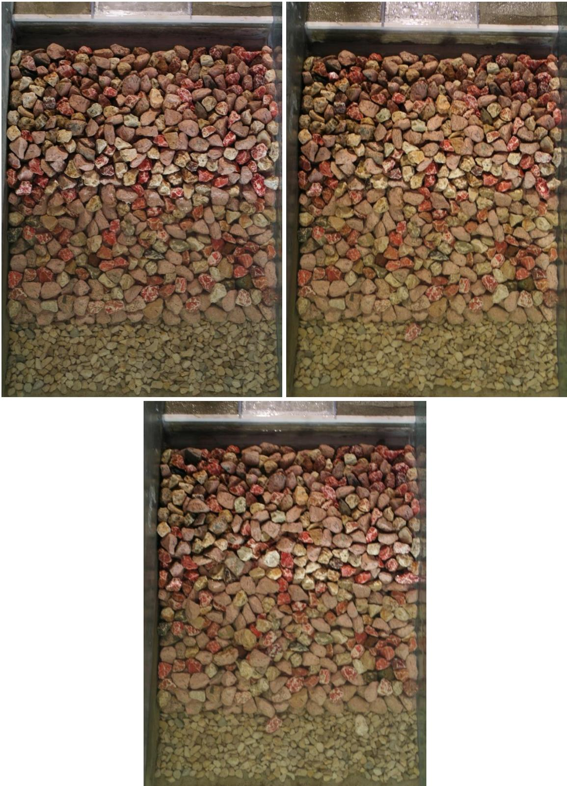
Figura 3-20 – Aspeto do manto da estrutura para o ensaio com o nível de maré de PM+S,  $T_p=15$  s: início do ensaio (à esquerda, em cima), após atuação de  $H_s=2.0$  m (à direita, em cima) e de  $H_s=3.0$  m (em baixo)
