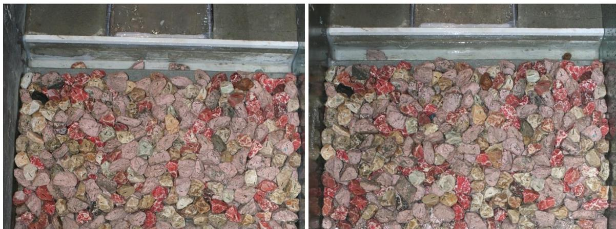
Figura 3-21 – Queda de blocos de enrocamento para a caleira para o ensaio com o nível de maré de PM+S, após a atuação de  $H_s=3.0$  m:  $T_p=12$  s (à esquerda) e  $T_p=15$  s (à direita)
