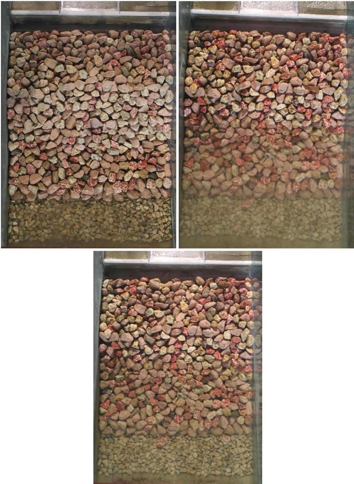
Figura 3-19 – Aspeto do manto da estrutura para o ensaio com o nível de maré de PM+S,  $T_p=12$  s: início do ensaio (à esquerda, em cima), após atuação de  $H_s=2.0$  m (à direita, em cima) e de  $H_s=3.0$  m (em baixo)
