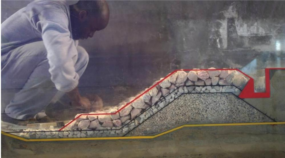
Figura 3-13 – Aspeto da construção do manto resistente da estrutura
