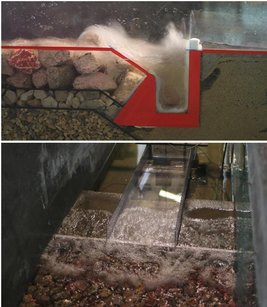
Figura 3-24 – Aspeto de galgamentos observados no decurso dos ensaios para o nível de maré de PM+S,  $T_p=12$  s e  $H_s=3.0$  m
