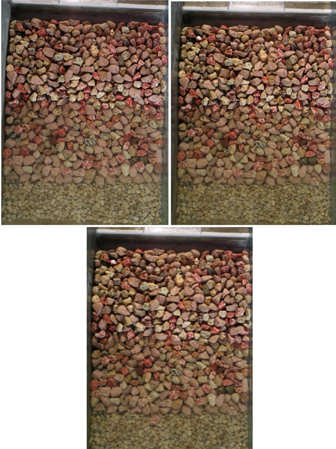
Figura 3-18 – Aspeto do manto da estrutura para o ensaio com o nível de maré de PM+S,  $T_p=8$  s: início do ensaio (à esquerda, em cima), após atuação de  $H_s=2.0$  m (à direita, em cima) e de  $H_s=3.0$  m (em baixo)
