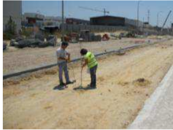
Figura 5.30 | Ensaio da garrafa de areia (à esquerda) e georreferenciação de pontos (à direita)
