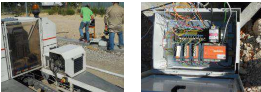
Figura 5.37 | Ensaios FWD conciliados com leituras de instrumentação (extensómetros verticais)
