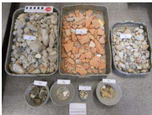
Figura 5.21 | Constituintes da amostra de Betão Britado Misto (BM(T))
