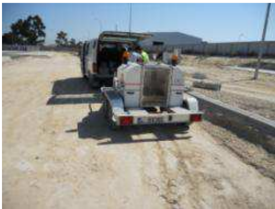
Figura 5.31 | Ensaios FWD (à esquerda) e de radar de prospeção (à direita)
