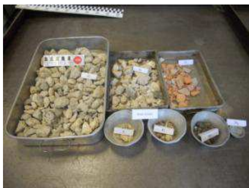
Figura 5.22 | Constituintes da amostra de Betão Britado (B(T))
