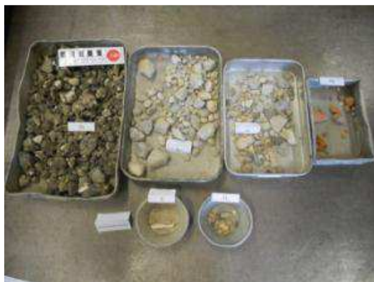
Figura 5.23 | Constituintes da amostra de Mistura Betuminosa Britada ( BET-B(T) )
