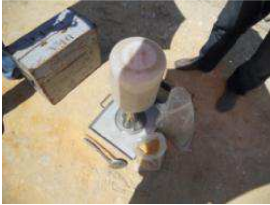
Figura 5.30 | Ensaio da garrafa de areia (à esquerda) e georreferenciação de pontos (à direita)
