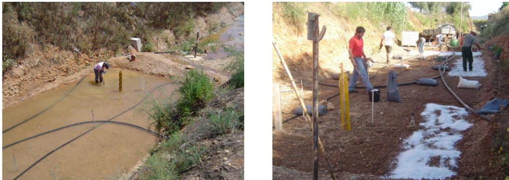
Fig. 15 - Modelos físicos *in situ*: bacias de infiltração no leito do rio Seco para ensaios no aquífero arenoso da Campina de Faro
