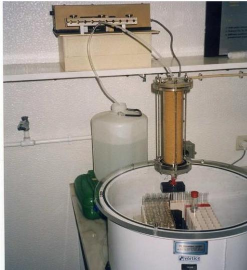
Fig. 8 - Coluna de lixiviação do NAS/DHA/LNEC para o estudo do transporte de contaminantes nas zonas saturada e não saturada do solo (Leitão, 2005)
