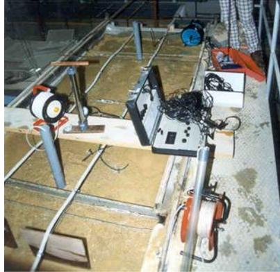
Fig. 12 - "Aquífero artificial" equipado para ensaios na zona não saturada do solo (Leitão, 1997)
