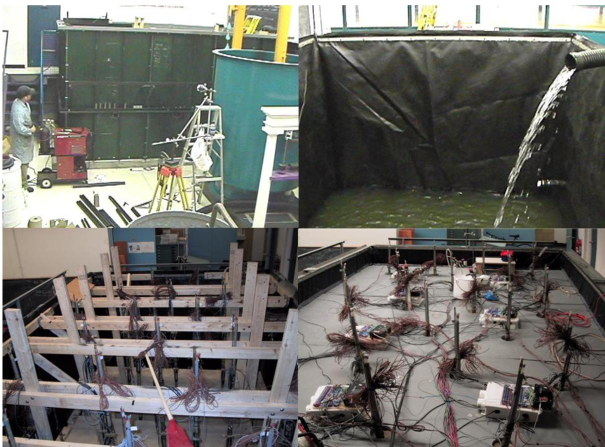
Fig. 17 – Modelo a escala intermédia da Universidade de Vermont para o estudo de fluxos e transporte de contaminantes de águas subterrâneas (Doris *et al.*, 2012)
