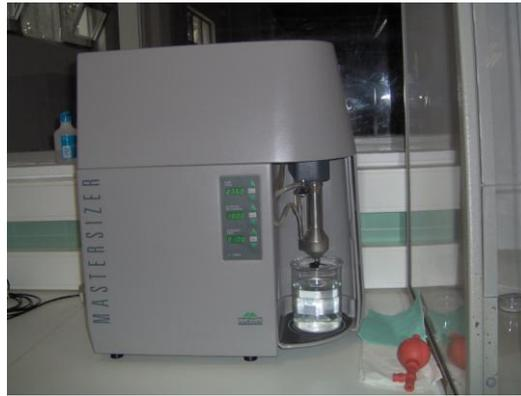
Fig. 4 - Unidade ótica para análise granulométrica por difração laser instalada na Estação Experimental de Sedimentos Coesivos (DHA/NEC)
