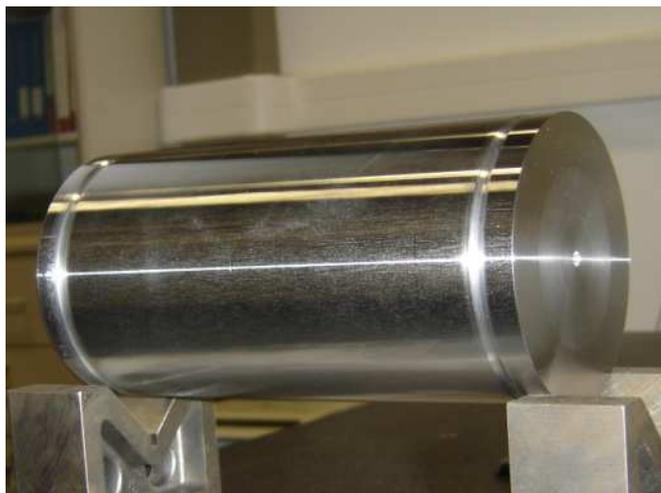
**Figura 1** – Corpo cilíndrico do transdutor de calibração.
