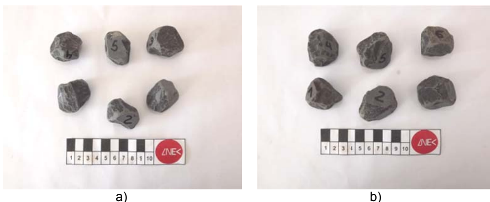
Figura 3.32 Exemplo de provetes utilizados nos ensaios de caracterização física: a) Bas_DMA_A; b) Bas_DMA_L
