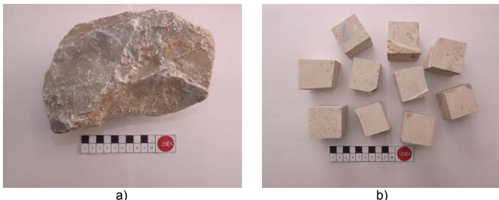
Figura 3.37 Primeira fase de preparação dos provetes de calcário: a) amostra inicial; b) 10 cubos provenientes da máquina de corte
