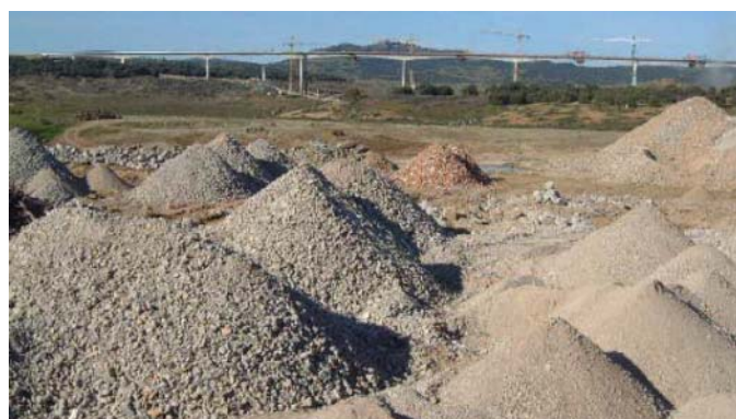
Figura 3.4 Armazenamento dos RCD-R no parque (adaptado de Almeida, 2011)
