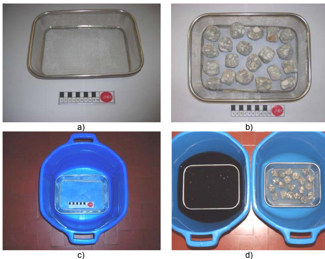
Figura 3.42 a) Cesto de rede metálica inoxidável; b) 20 provetes de AB_{RCD} colocados no cesto de rede metálica; c) recipiente em plástico com cesto de rede metálica; d) 20 provetes de AB_{RCD} imersos no lixiviado e 20 em água
