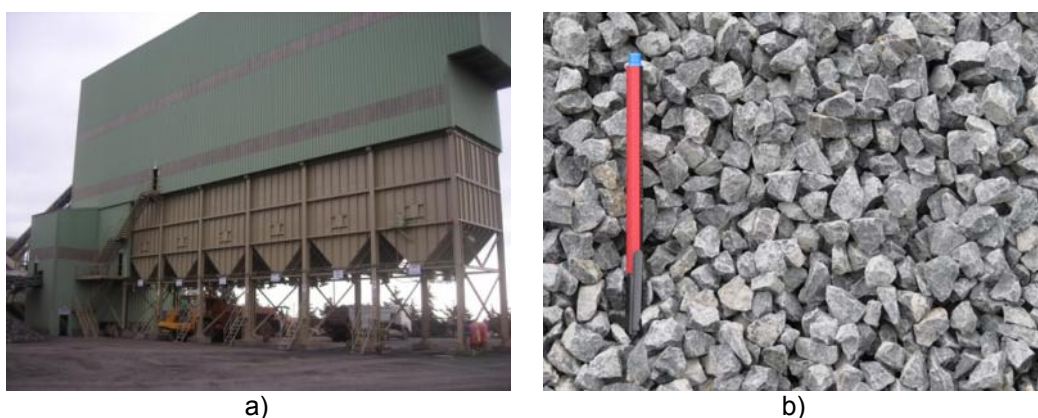
Figura 3.15 a) Unidade de britagem com seis silos; b) brita 2, 10 mm - 16 mm
