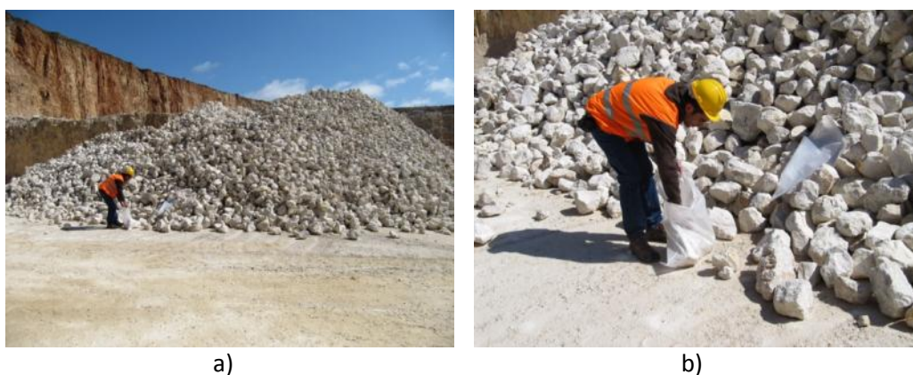
Figura 3.23 Amostragem do calcário: a) pilha de material existente no parque de armazenamento da central de processamento da Pedreira Vale Grande nº 2; b) recolha da amostra
