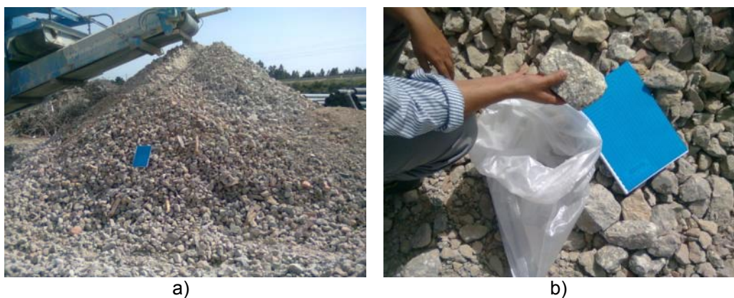
Figura 3.5 Amostragem do AB_{RCD} : a) pilha de material existente na central de reciclagem da Demotri no seixal; b) recolha da amostra
