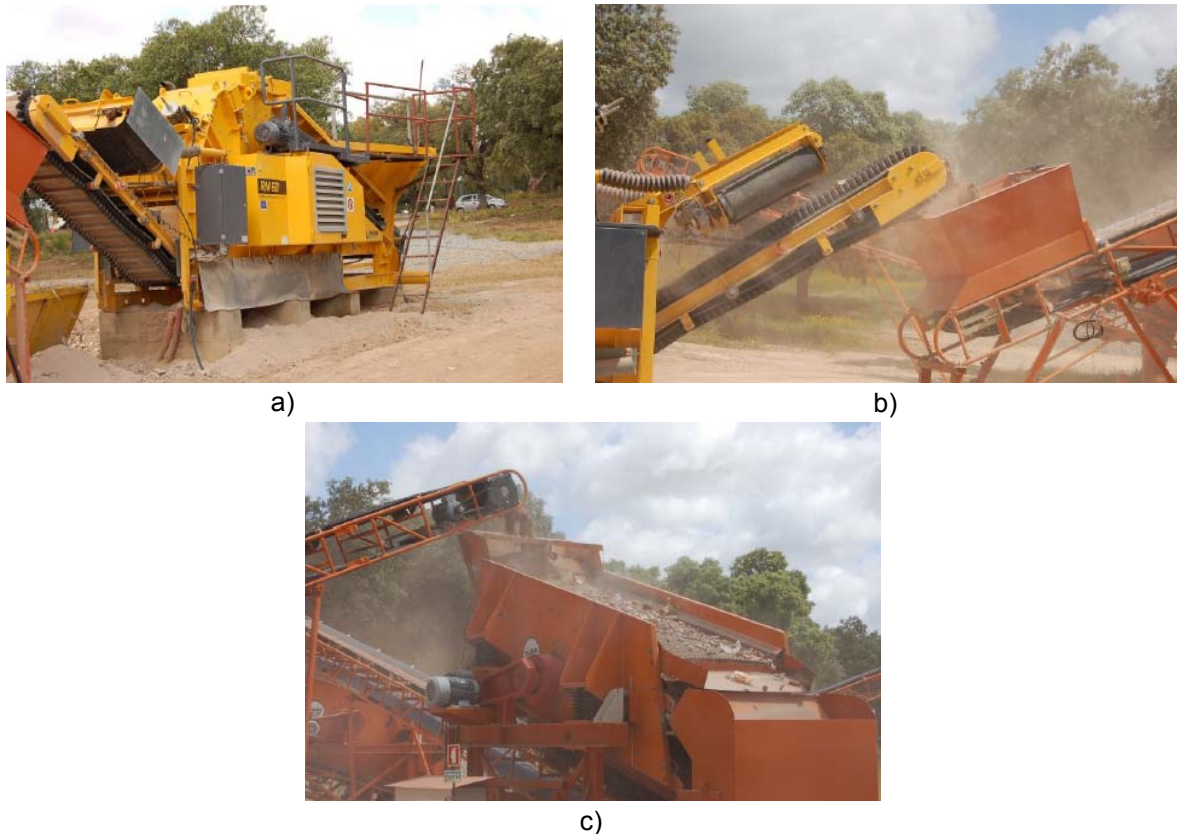
Figura 3.3 Exemplos do equipamento utilizado durante a quarta etapa de processamento dos RCD: a) britagem; b) separação magnética; c) crivagem (adaptado de Algarvio, 2009)
