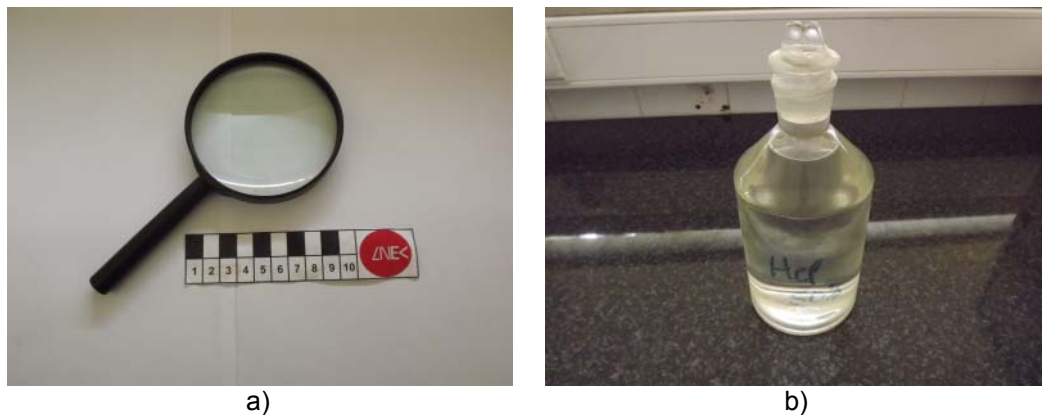
Figura 3.26 Material utilizado no estudo macropetrográfico: a) lupa (régua de escala em cm); b) frasco com HCl
