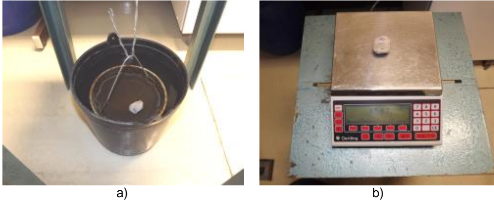
Figura 3.34 Procedimento para a realização da terceira etapa do ensaio de caracterização física: a) pesagem da massa saturada de um provete de calcário imerso; b) pesagem da massa saturada de um provete de calcário com as faces enxutas
