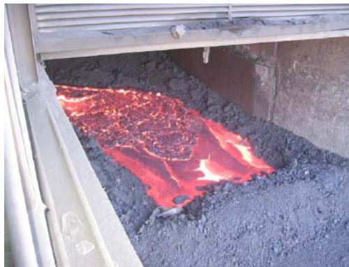
Figura 3.7 Vazamento das escórias para um fosso (adaptado de Roque et al. , 2006)
