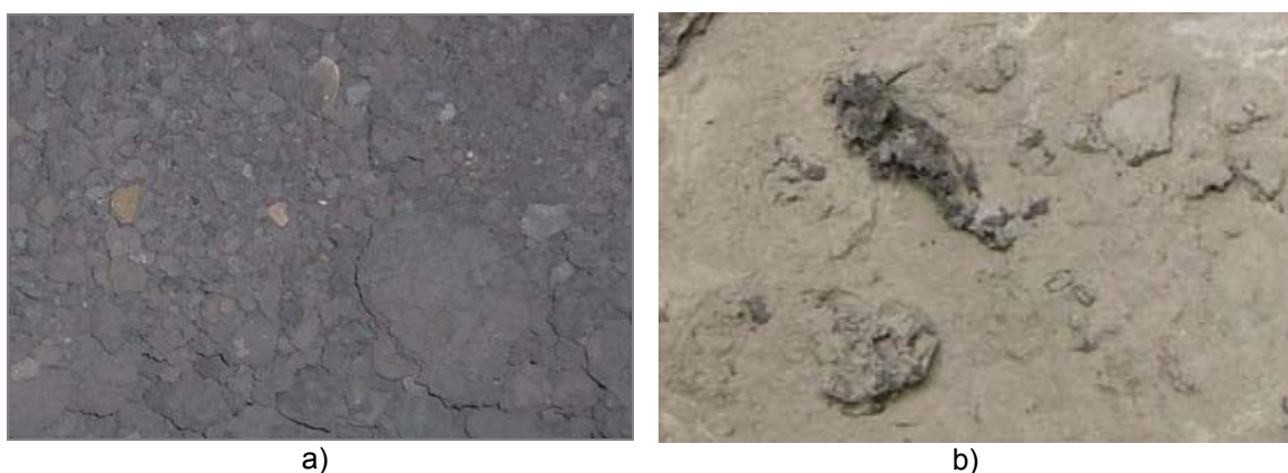
Figura 2.18 Escórias de aciaria de FAE: a) negra e b) branca (adaptado de Puy, 2007)
