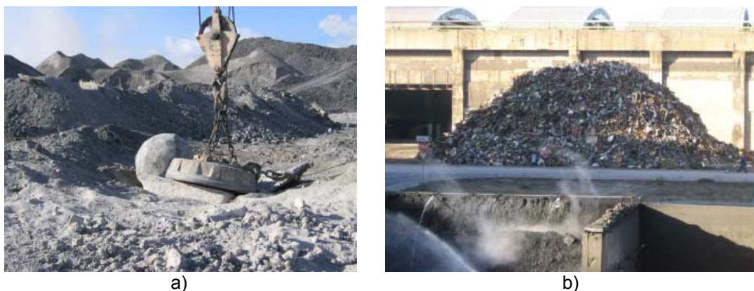
Figura 3.9 a) Fragmentação; b) parte metálica obtida da separação das partes metálicas e não metálicas, a reutilizar na produção do aço (adaptado de Roque et al. , 2006)
