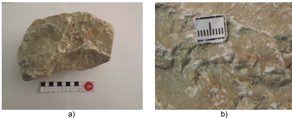
Figura 3.53 Aspeto macroscópico do provete Cal: a) vista geral e b) vista pormenorizada
