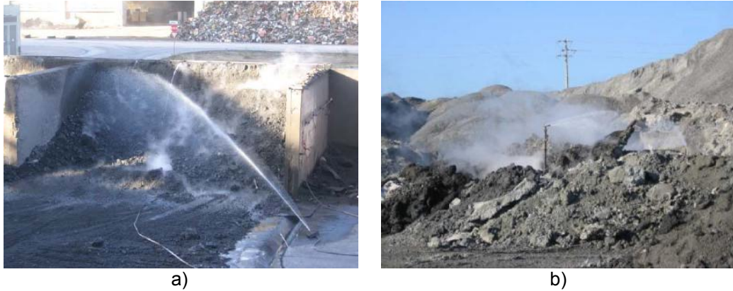
Figura 3.8 a) Arrefecimento primário das escórias na zona impermeabilizada; b) arrefecimento secundário (adaptado de Roque et al. , 2006)
