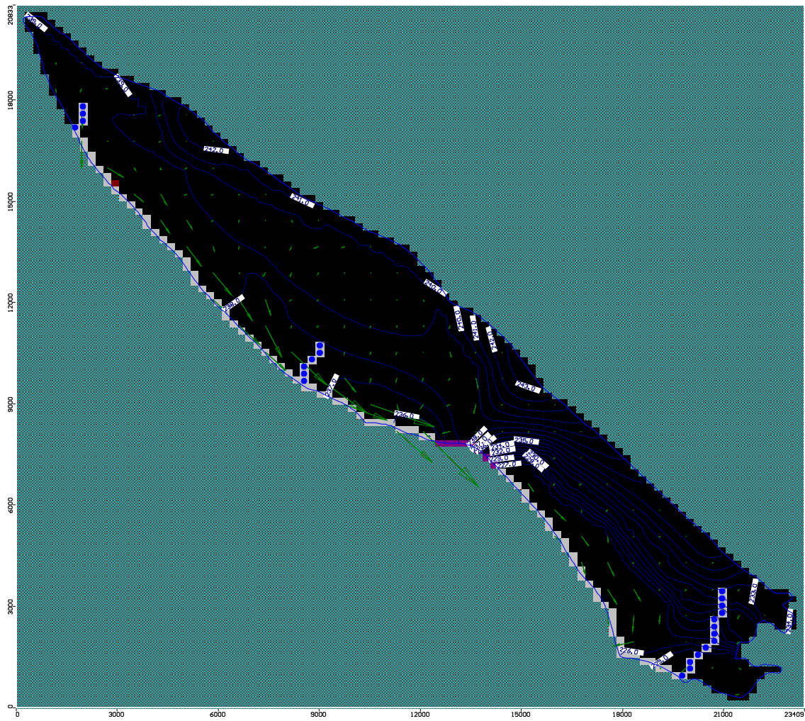
Figura 1.13 – Vectors de fluxo e isopiezas construídas com as condições de fronteira definidas considerando o domínio de escoamento homogéneo (Variante 2)
