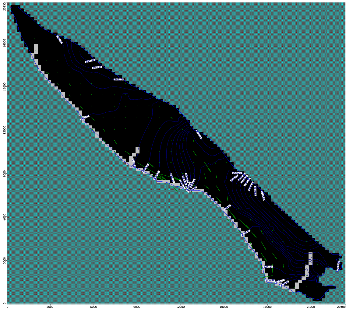
Figura 1.10 – Vectors de fluxo e isopiezas construídas com as condições de fronteira definidas considerando o domínio de escoamento heterogéneo (Variante 1)
