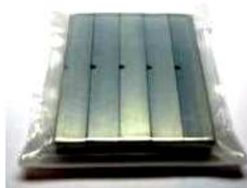
Figura 2 – Conjunto de provetes metálicos de referência para ensaio de choque Charpy.
