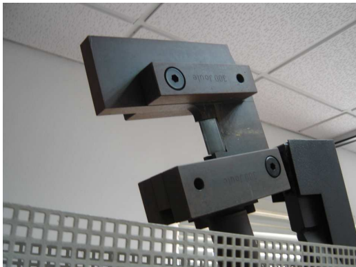
Figuras 3 e 4 – Aresta de choque do pêndulo (à esquerda) e zona de apoio dos provetes (à direita).
