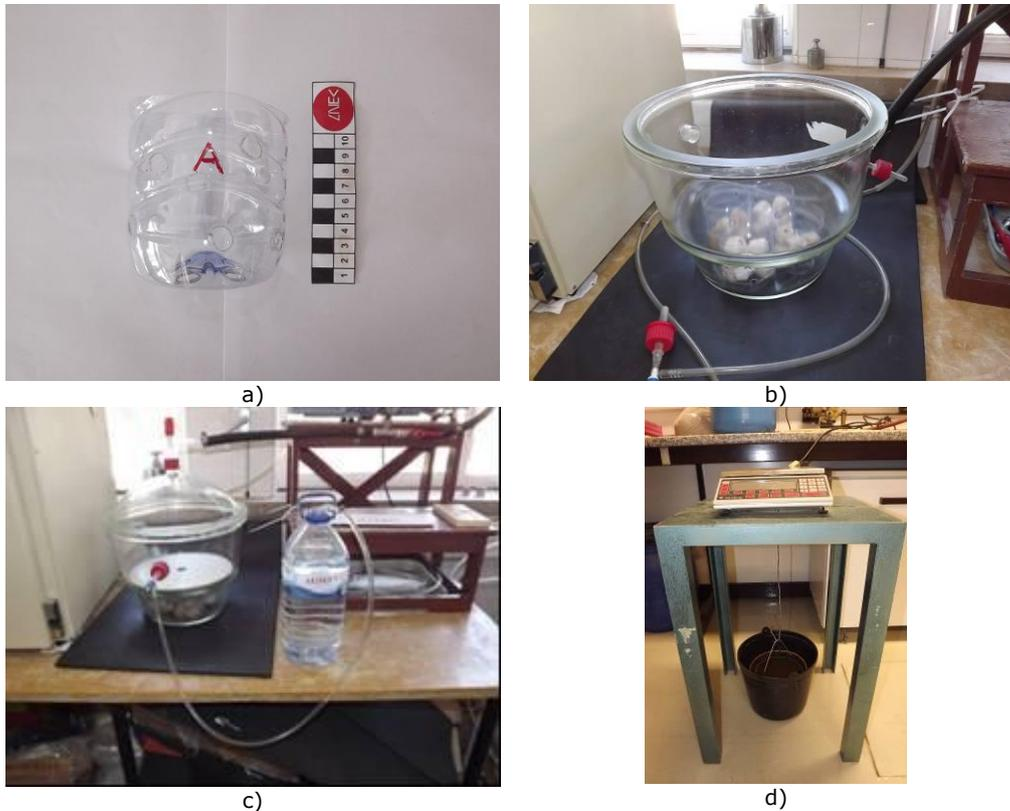
Figura 4 - Equipamento utilizado no ensaio: a) recipiente de plástico; b) exsicador aberto; c) exsicador, reservatório de cinco litros com água desmineralizada e bomba de vácuo e d) balança com precisão centesimal, cesto em rede metálica e balde de plástico
