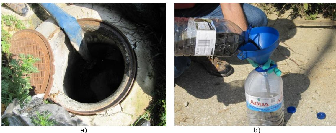
Figura 3 – Amostragem do lixiviado: a) bombagem do lixiviado a partir do sistema de drenagem e recolha dos lixiviados do aterro; b) transferência do lixiviado para os reservatórios de armazenamento, transportados para o LNEC
