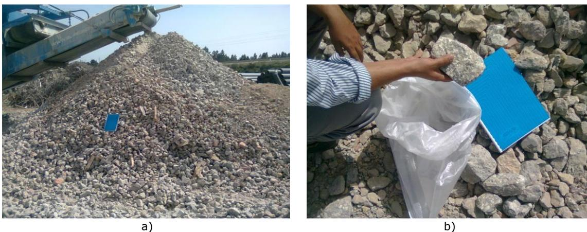
Figura 2 – Amostragem do AB<sub>RCD</sub>: a) pilha existente na central móvel da Demotri, S.A., no Seixal; b) recolha da amostra
