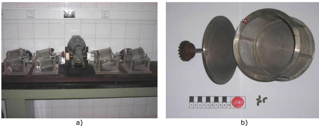
Figura 5 - Equipamento utilizado no ensaio DMA: a) vista geral do equipamento e b) pormenor do tambor em aço inoxidável
