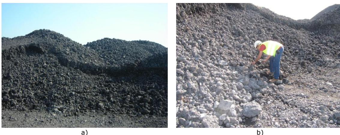
Figura 1 – Amostragem do ASIC: a) pilha existente no parque de armazenamento da SN do Seixal; b) recolha da amostra
