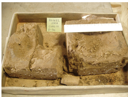
Figura 9 – Exemplo de Dois Provetes Cúbicos, a) Um com o Teor em Água Após 24 Horas na Estufa a 40°C e b) Outro Seco a 100°C
