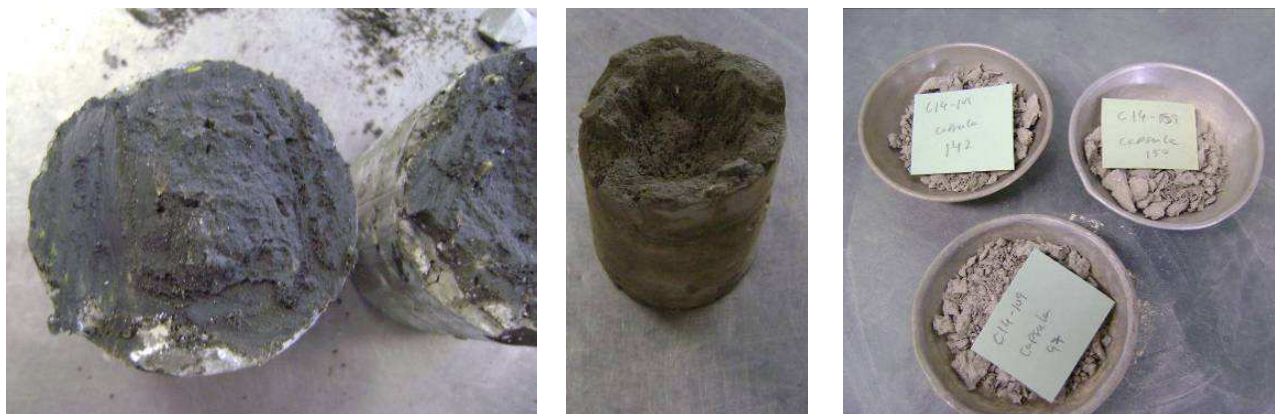
Figura 12 – Provede Cilíndrico e seus Fragmentos Após Secagem em Estufa para as Elaboraões de Cápsulas para Análise
