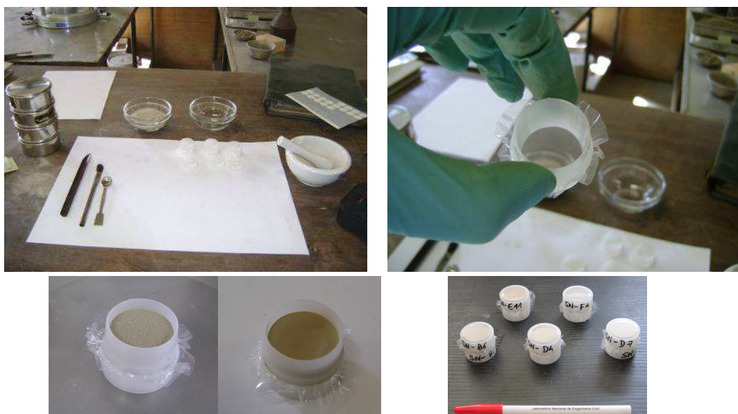
Figura 6 – Procedimento Utilizado para a Produção dos Padrões a Usar no Estudo. Cápsulas-Padrão a 0, 5, 10, 15 e 20% de Cimento
