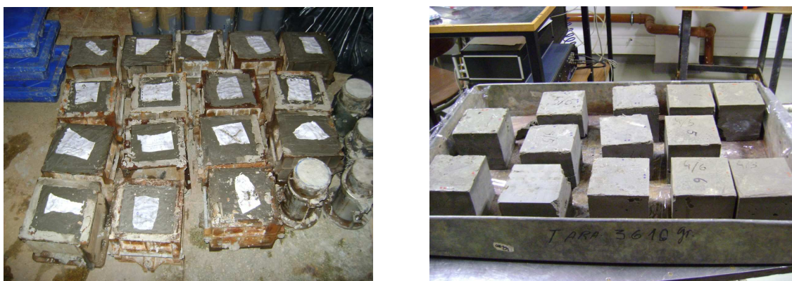
Figura 8 – Moldes Cúbicos e Cilíndricos Metálicos de Massas Frescas e Provetes Cúbicos Após 16 Dias de Cura
