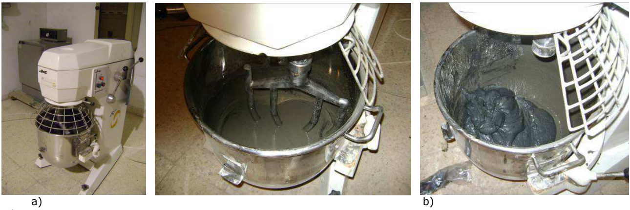
a) b) c) Figura 10 – a) Batedeira Felino BT; b) Realização da Calda de Cimento; c) Adição de Lodo com Teor em Água Natural para a Obtenção da Mistura Solo-Cimento
