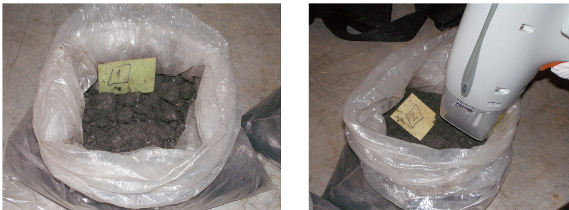
Figura 2 – Amostras de Lodos de Aveiro e Realização de uma Determinação Direta de Ca por FRX
