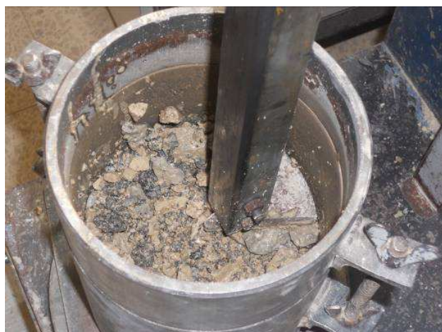
Figura 5.13 | Compactação da amostra 70% ABGE_N + 30% Mistura Betuminosa Fresada (ARA_R3.2)
