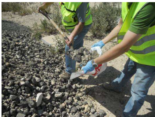
Figura 5.2 | Colheita de amostras de RCD, no Seixal, para caracterização laboratorial
