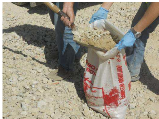
Figura 5.2 | Colheita de amostras de RCD, no Seixal, para caracterização laboratorial
