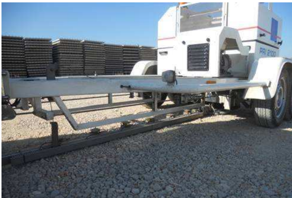
Figura 5.17 | Equipamento FWD do LNEC
