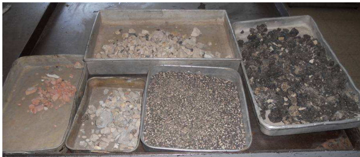
Figura 5.5 | Constituintes da amostra de Mistura Betuminosa Britada (ARA_R3.1)
