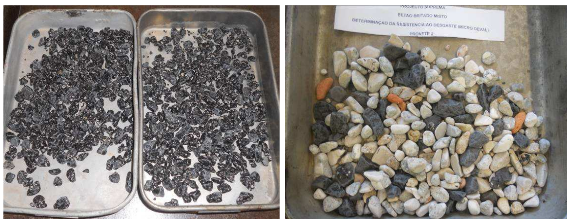
Figura 5.11 | Aspeto das partículas dos RCD após o ensaio de desgaste micro-Deval
