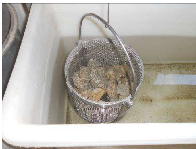
Figura 5.9 | Aspetto do cesto de rede metálica para ensaio da fração 63/31,5 mm
