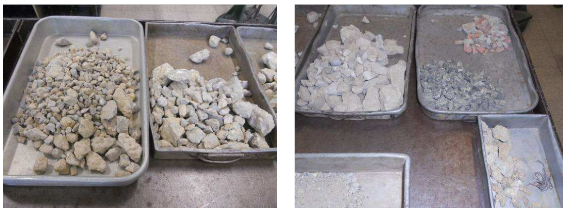
Figura 5.6 | Constituintes da amostra de Betão Britado Misto (ARM_R2)
