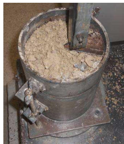
Figura 5.13 | Compactação da amostra 70% ABGE_N + 30% Mistura Betuminosa Fresada (ARA_R3.2)
