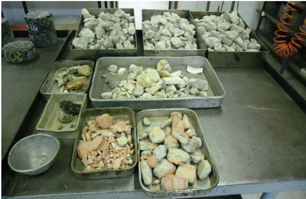
Figura 5.7 | Constituintes da amostra de Betão Britado (ARB_R1)
