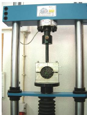
Figura 1: Equipamento para ensaio uniaxial.
