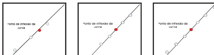
Figura 6 – Regressão linear em torno do ponto de inflexão com amostras de pontos experimentais com dimensões distintas.
