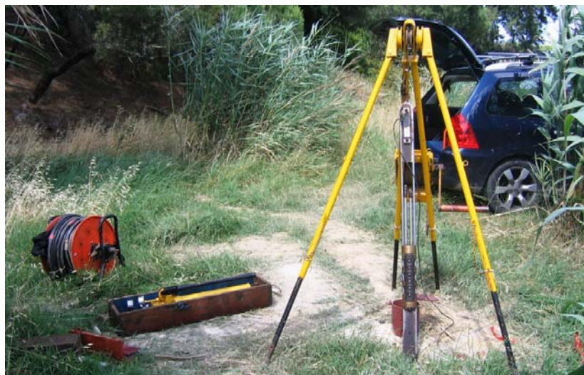
Figura 6.92 – Martelo sísmico para furos utilizado nos ensaios sísmicos entre os furos S1 e S2.
