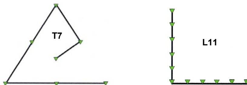
Figura 3.6 – Dispositivos bidimensionais de geofones (triângulos a verde), utilizados na aquisição passiva de dados do MOS: T7 – triângulo equilátero com 7 geofones; L11 – 11 geofones equiespaçados ao longo dos 2 braços perpendiculares do 'L'. Adaptada de [Geometrics 2006].
