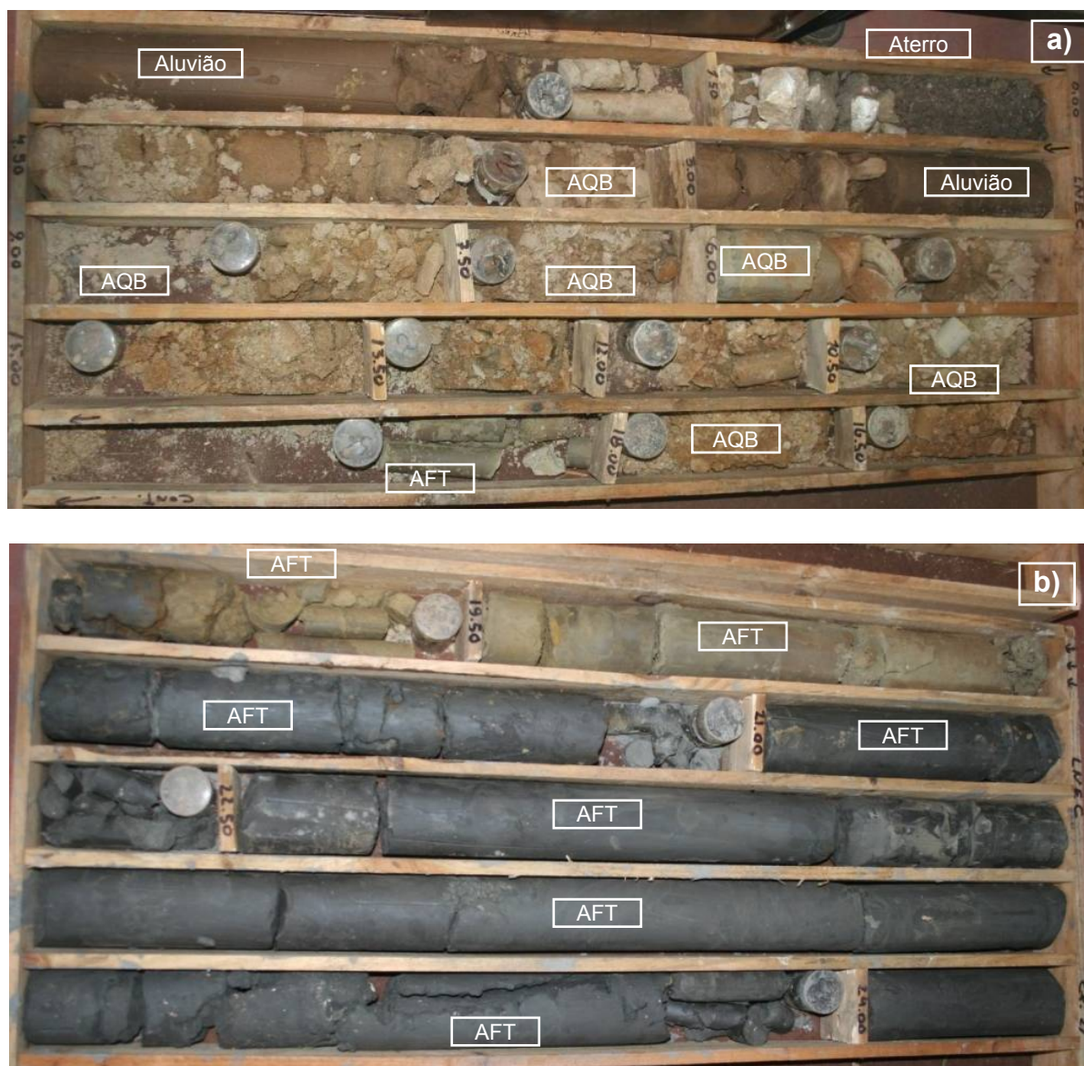
Figura 6.89 – Amostras recolhidas ao longo da sondagem S1: a) da superfície até cerca de 18.5m de profundidade; b) entre cerca de 18.5 e 24.5m de profundidade.
