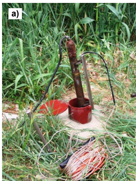
Figura 6.93 – Receptores utilizados nos ensaios sísmicos entre os furos S1 e S2: a) geofone para aquisição das ondas S (com o patim mecânico aberto); b) cabo de hidrofones para aquisição das ondas P.
