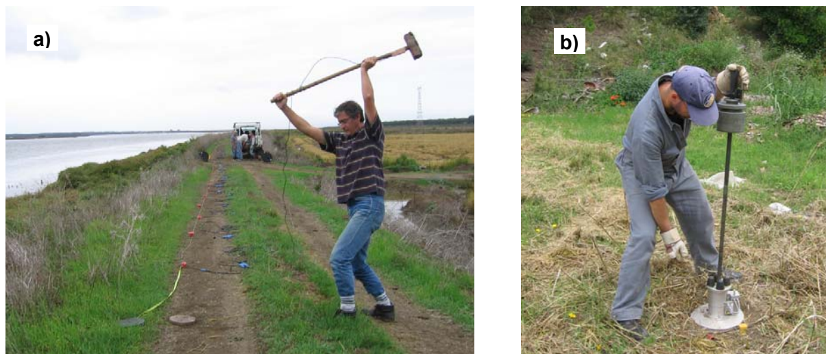
Figura 3.4 – Fontes sísmicas impulsivas de percussão, utilizadas na aquisição activa de dados do MOS: a) impacto de marreta; b) queda de peso (DIP).
