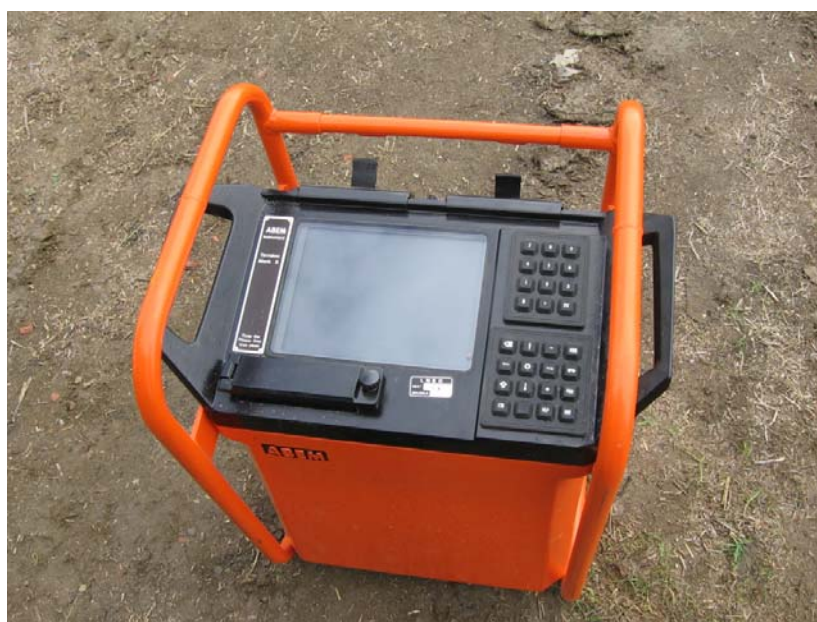
Figura 3.2 – Sismógrafo ABEM Terraloc MK6 (com 48 canais).
