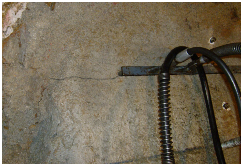
Figura 8 – Fenda de tracção visível da superfície exterior do maciço rochoso
