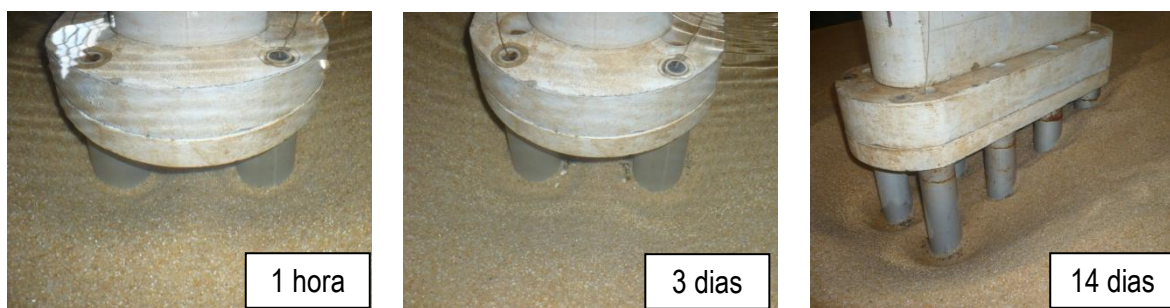
Figura 10: Fotografias da cavidade de erosão no ensaio 1
