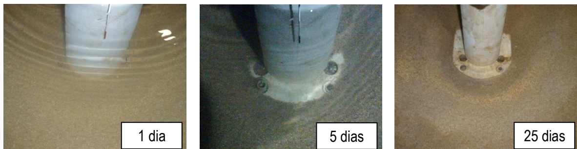
Figura 16: Fotografias da cavidade de erosão no ensaio 3
