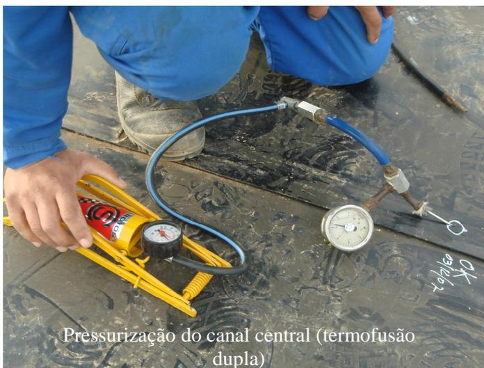
Figura 15 – Ensaio de pressão de ar
