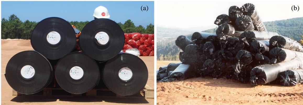
Figura 6 – Exemplos de armazenamento: (a) adequado e (b) inadequado
