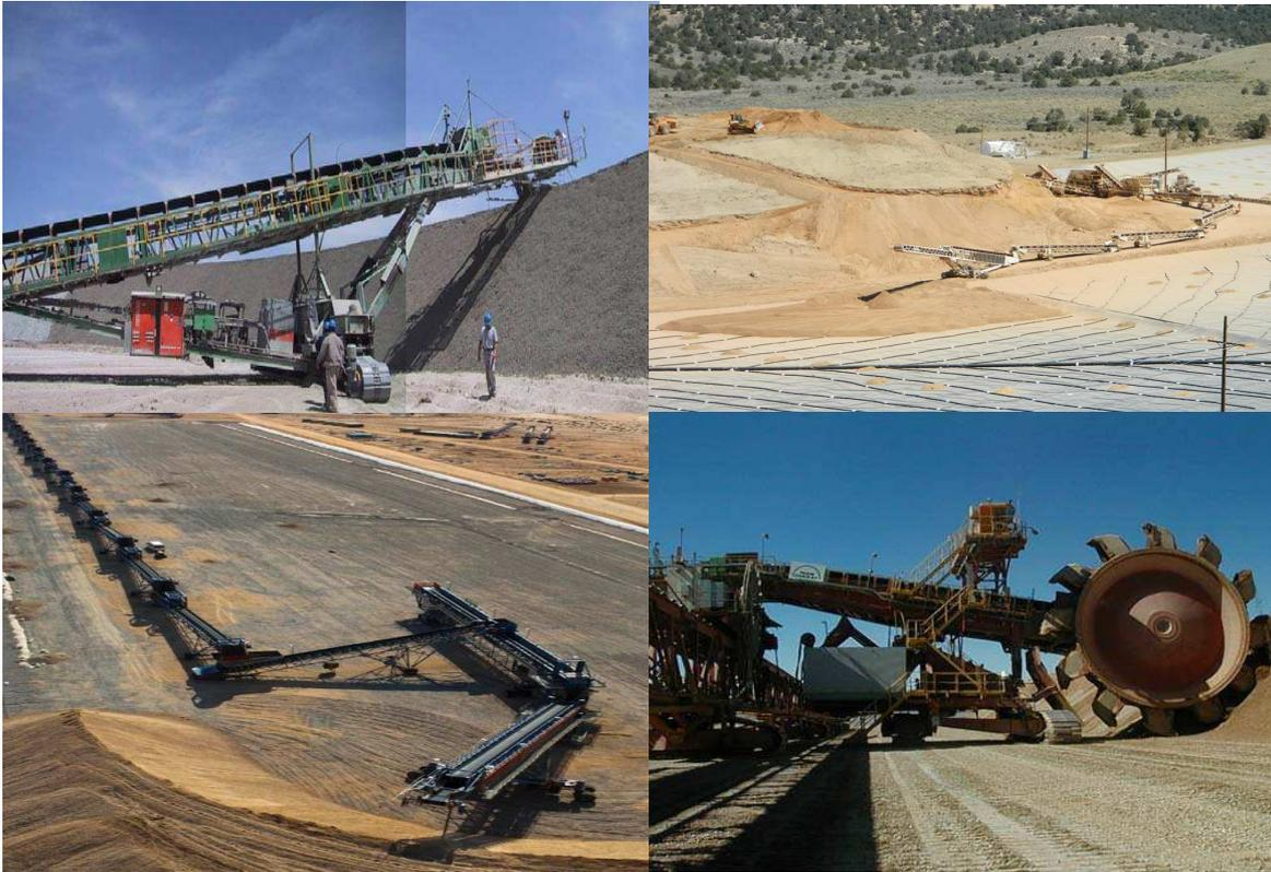
Figura 38 – Equipamentos de transporte e deposição do minério para lixiviação em pilhas (Steemson & Smith, 2009)
