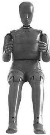
Figura 5 – Dummy Hybrid III masculino adulto do percentil 50 [66].
