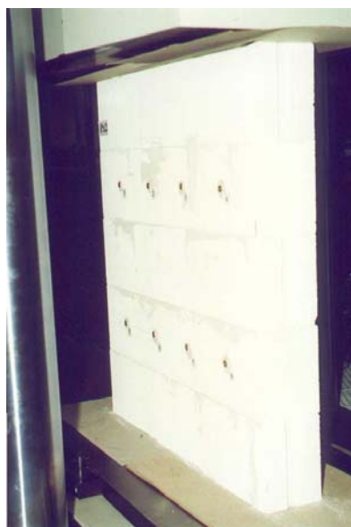
Figura 1b - Aspecto do provete de alvenaria de blocos de betão celular autoclavado PX2 no ensaio de compressão vertical
