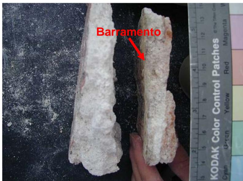
Figura 29 – Amostra SE4, argamassa de reboco e regularização de cor branca e barramento fino na cor tijolo.
