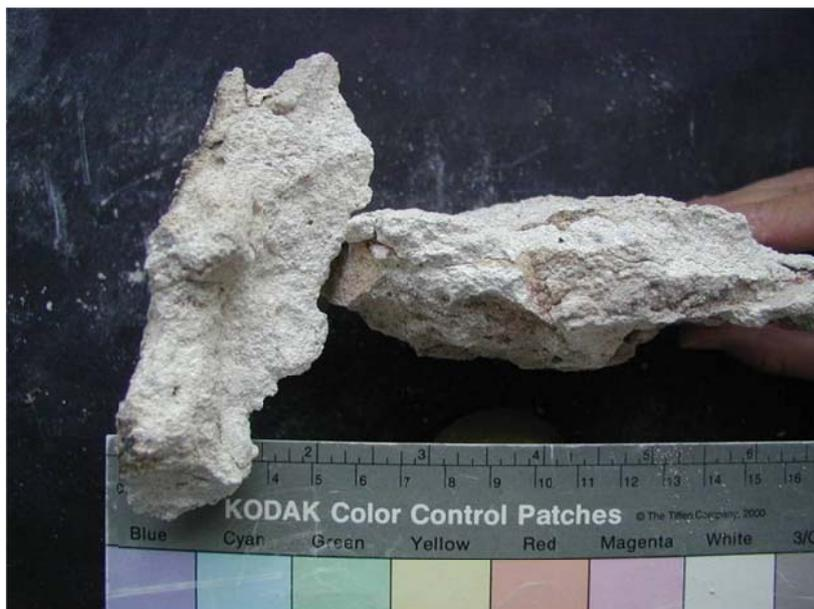
Figura 28 – Amostra SE2, argamassa de reboco de cor branca. No difractograma nota-se que os produtos de alteração, tais como cloroaluminatos e etringite, não ocorrem ou estão em menor quantidade comparativamente à amostra SE1-Int. Notação: C – Calcite; F – Feldspatos; Q – Quartzo; A - Anfíbolos.
