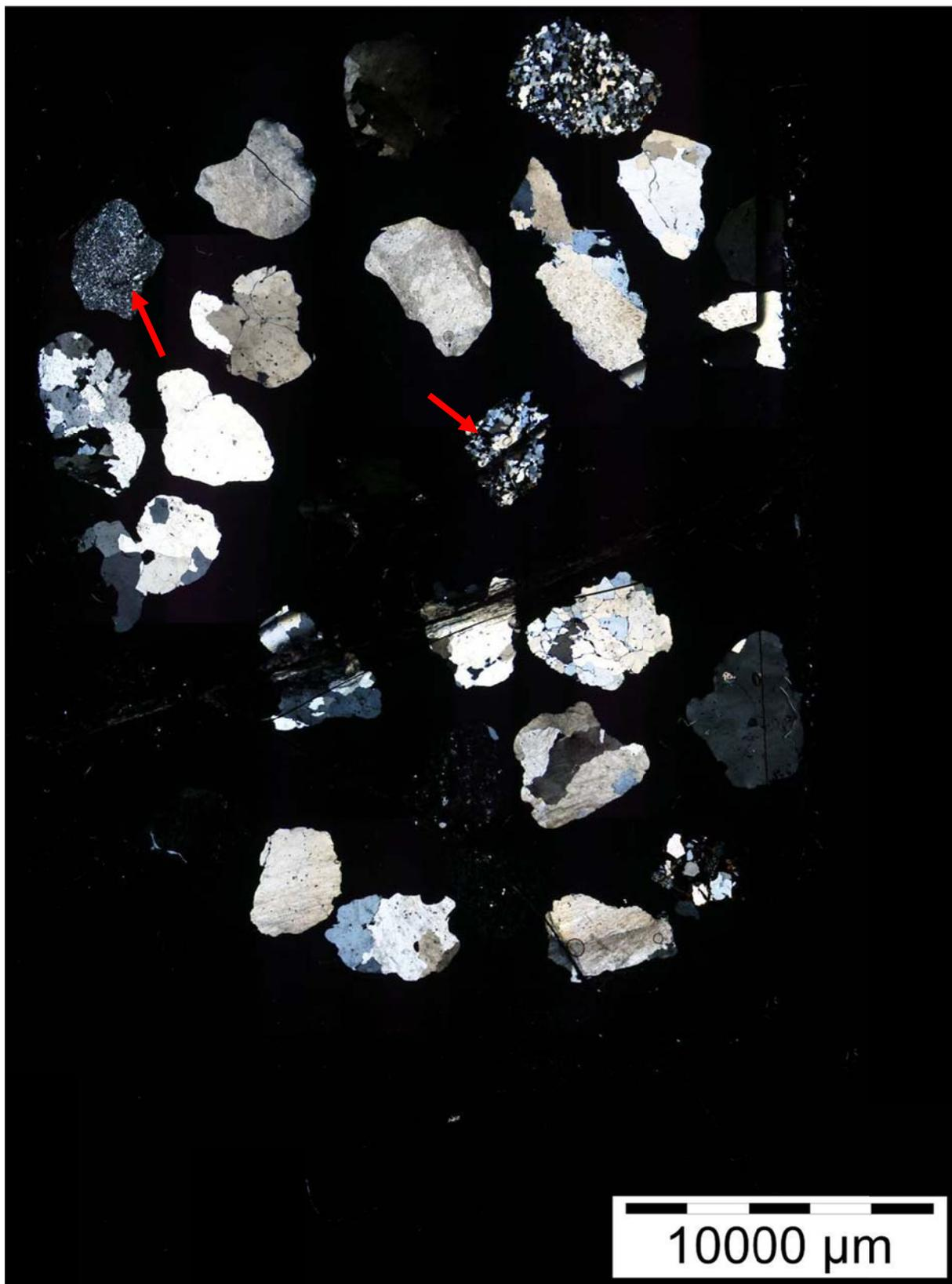
Figura 19 – Observação ao microscópio petrográfico da Areia 2 classificada de não reactiva por ensaios de expansão em barra de argamassa (imagem em polarizadores cruzados). Apesar da classificação de “não reactiva”, notam-se feições características de minerais potencialmente reactivos (setas vermelhas, quartzo policristalino e criptocristalino) porém em menor quantidade que nas amostras Areia 1 e Brita 1.
