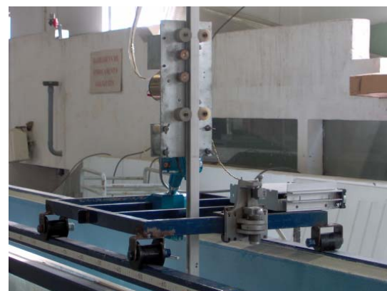
Figura 1 – Descrição pictórica do mecanismo de movimentação vertical e fotografia mostrando o aspecto exterior do aparelho no canal experimental.
