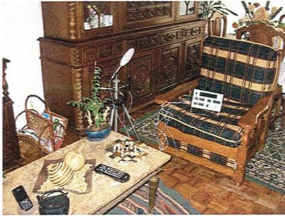
Fig. 5 – Sistema de medição e de registo de parâmetros ambientes
