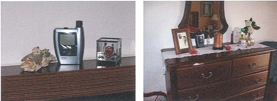
Fig. 4 – Sistema de medição e de registo da temperatura e da humidade relativa do ar interior
