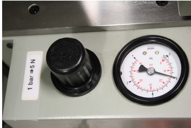
Figuras 6 e 7 – Manômetros de indicação da pressão na tomada de fornecimento de ar comprimido (à esquerda) e na entrada do banco do sistema de medição unidimensional (à direita)
