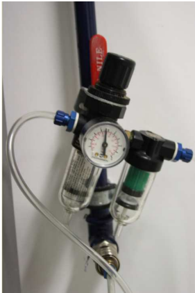
Figuras 6 e 7 – Manômetros de indicação da pressão na tomada de fornecimento de ar comprimido (à esquerda) e na entrada do banco do sistema de medição unidimensional (à direita)
