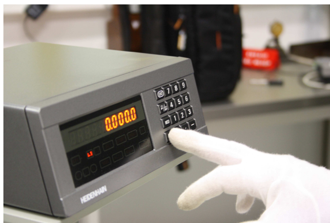
Figura 13 – Realização do zero do indicador
