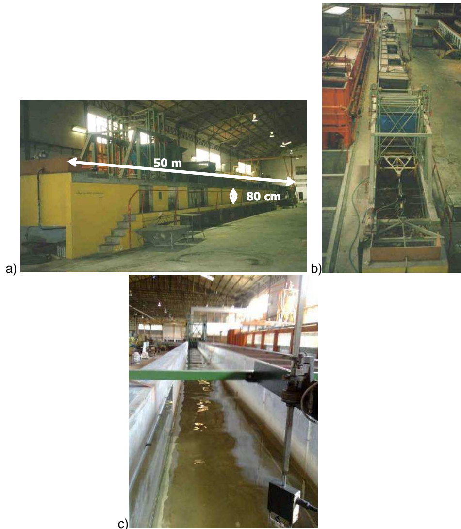
Figura 7 - Canal de ondas irregulares COI1: a) Vista exterior; b) Vista superior; c) Vista interior
