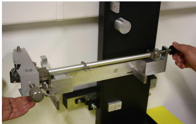
**Figura 18** – Determinação do centro de gravidade do pêndulo na estrutura de ensaio.
