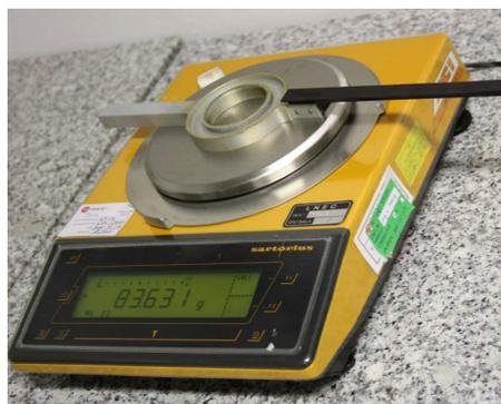
**Figuras 9 e 10** – Remoção de almofadas de feltro (à esquerda) e determinação da massa do ponteiro em instrumento de pesagem (à direita).
