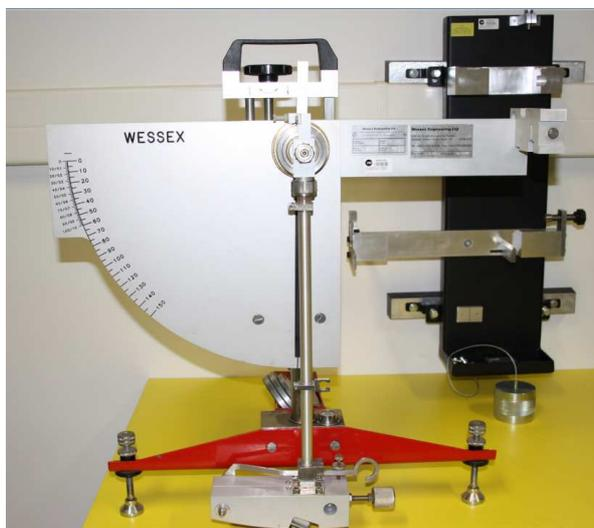
*Figura 1 – Pêndulo britânico (medidor de fricção).*
