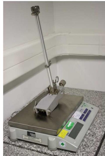
**Figura 16 – Pesagem do pêndulo.**
