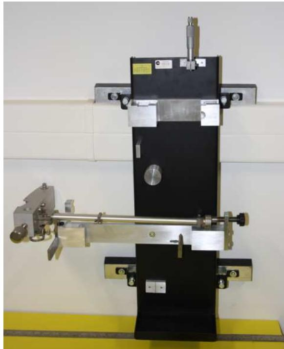
**Figura 5** – Estrutura dedicada para ensaio metrológico de pêndulos britânicos (medidores de fricção) instalada numa das salas de ensaio do LCAM/LNEC.
