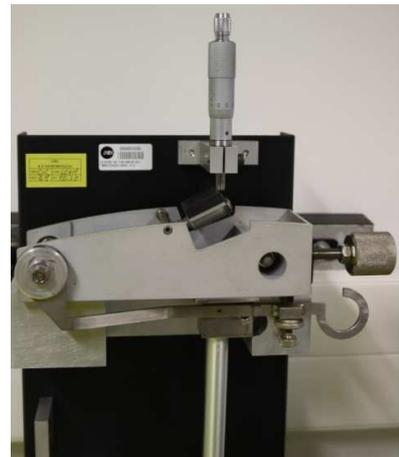
**Figuras 21 e 22** – Remoção de placa de cobertura do puxador (à esquerda) e montagem do pêndulo em posição invertida na estrutura dedicada de ensaio (à direita).
