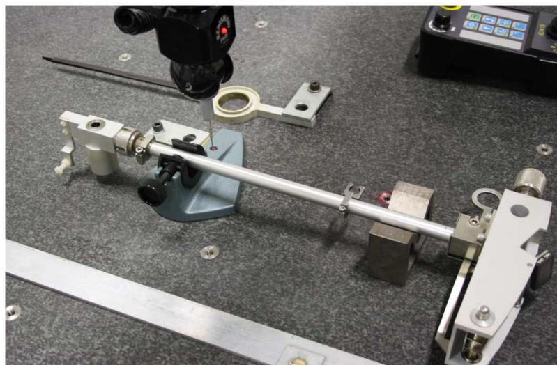
*Figura 20 – Medição da distância entre o centro de rotação e o centro de gravidade do pêndulo.*
