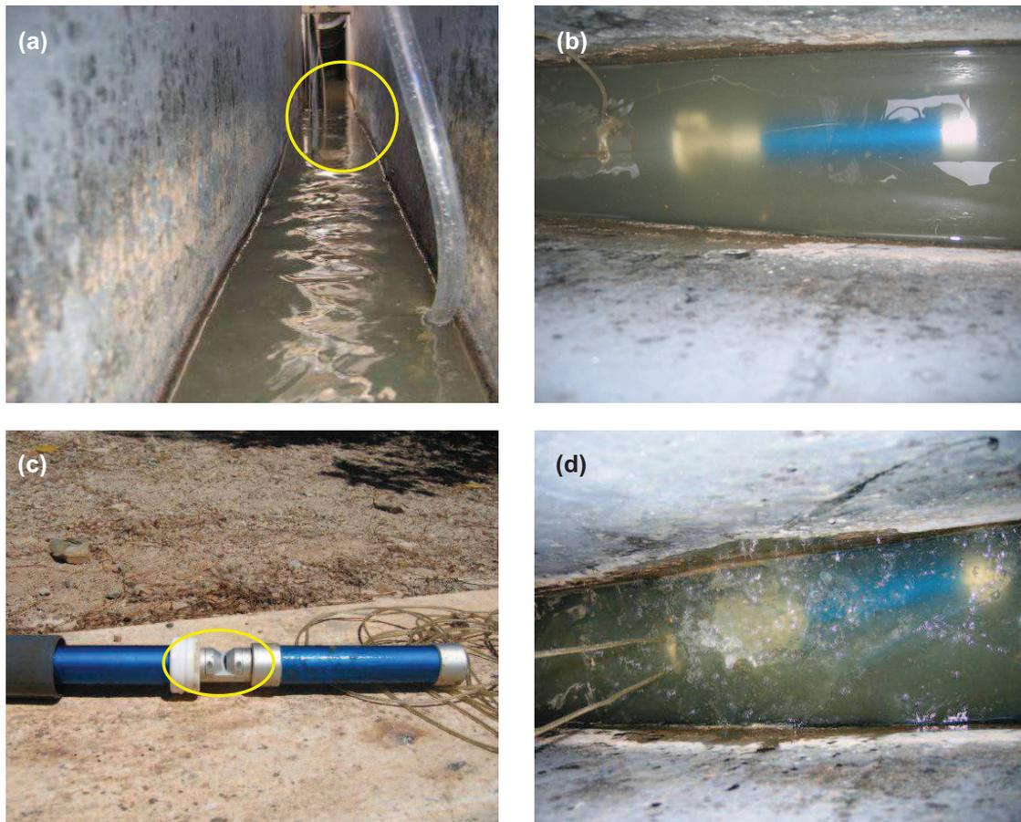
Figura 48 – Espectrofotómetro: (a) local de instalação; (b) sonda a realizar uma medição; (c) janelas de leitura e saídas de ar comprimido; (d) sonda em limpeza automática
