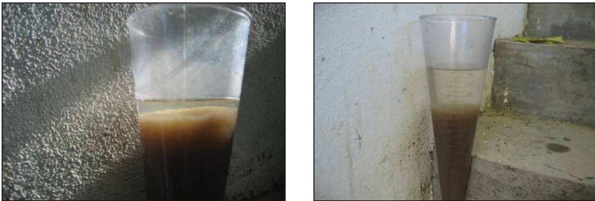
Figura 80 – Aspecto da sedimentabilidade das lamas em cone de Imhoff (após 30 minutos)
