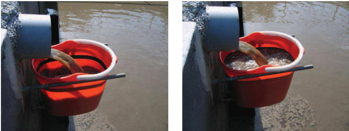
Figura 15 – Medição do caudal de lamas recirculadas (ponto CALR)
