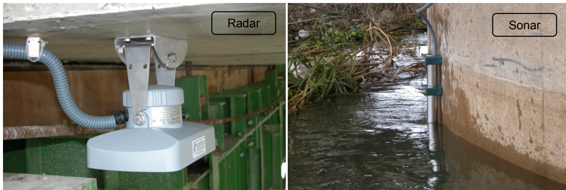
Figura 5. Monitorização do nível de água (radar) e da morfologia do fundo aluvionar do rio (sonar).
