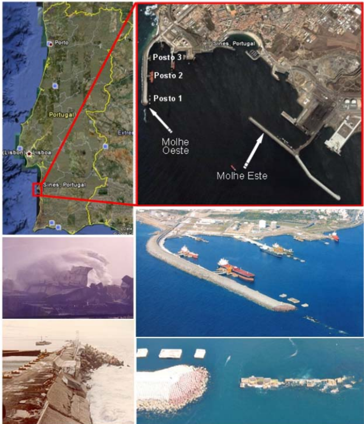
Figura 8 - Porto de Sines: localização, configuração actual (incluindo os destroços do molhe Oeste original) e aspecto dos estragos ocorridos em 1978/79 no molhe Oeste.
