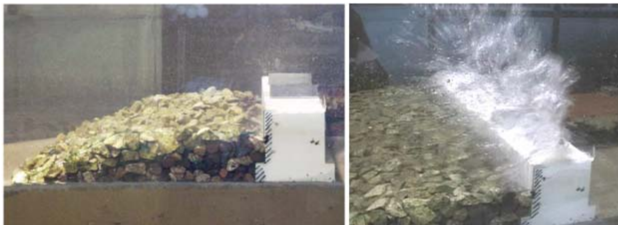
Figura 4 - Modelo físico da solução proposta para a reparação do molhe Sul do Porto da Póvoa de Varzim. Aspecto dos galgamentos observados.
