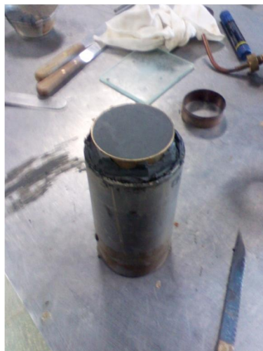
Figura 4.2 - Montagem dos provetes: Colocação do anel na amostra 2977.
