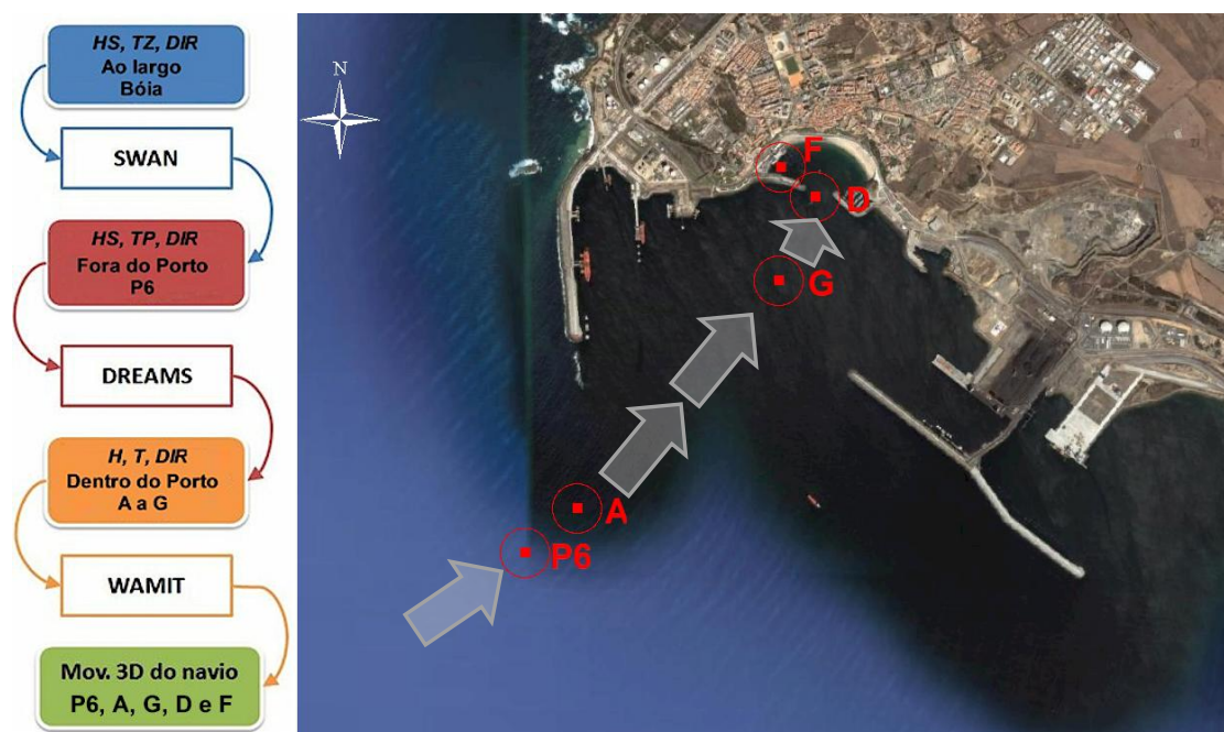
Figura 13 - Esquema de modelação para cálculo dos movimentos do navio no porto de Sines e localização dos pontos onde foi aplicado o modelo WAMIT (imagem Google Earth™).
