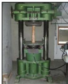
Figura 8 – Dispositivo de ensaio de compressão
