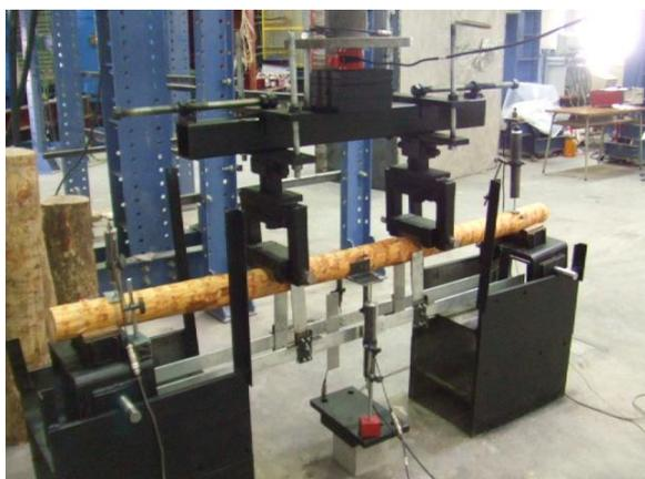
Figura 6 – Dispositivo de ensaio de flexão
