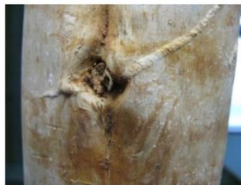
Figura 9 – Exemplo de uma rotura por compressão
