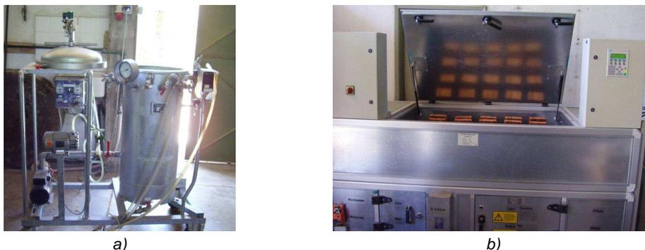
Figura 2 – Instalações para execução de ensaios de envelhecimento. a) Autoclave para realização dos ciclos de vácuo/pressão; b) Estufa com ventilação forçada para realização de ciclos de secagem
