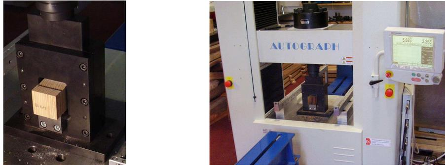
Figura 3 – Ensaio de resistência ao corte da junta colada.
