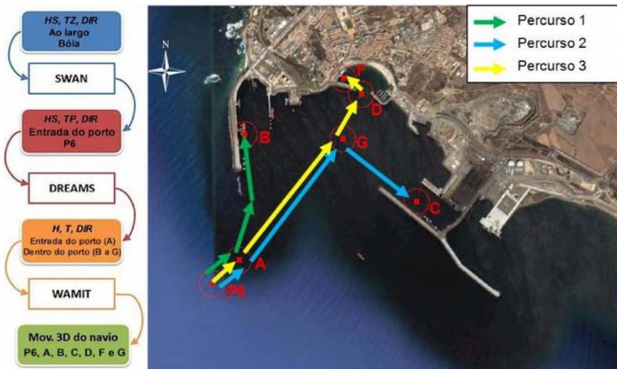
Figura 14 - Esquema de modelação para cálculo dos movimentos dos navios e localização dos pontos onde foi aplicado o modelo WAMIT (imagem Google Earth™).
