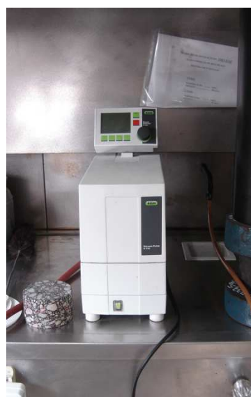
Figuras 1 e 2 – Picnómetro e sistema de vácuo utilizado pelo LNEC/PAVMAT.
