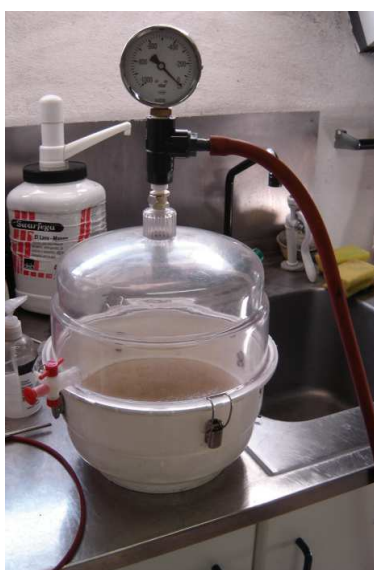
Figuras 1 e 2 – Picnómetro e sistema de vácuo utilizado pelo LNEC/PAVMAT.
