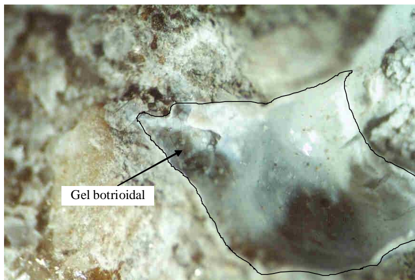
Figura 11 – Observação à lupa binocular e um poro recoberto de gel com uma morfologia botrioidal típica de alguns dos gels da RAS.
