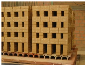
Figura 2.1.2 – Tijolo cerâmico empilhado antes da cozedura.
