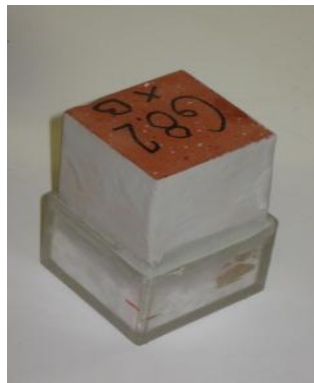
Figura 4.4.1 – Provetes sobre caixa acrílica, sendo a ligação vedada com mástique.
