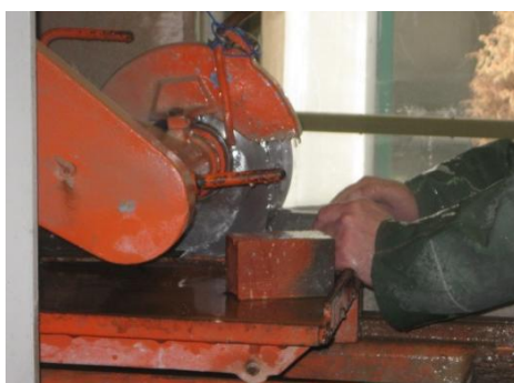
Figura 3.2.1 - Tijolo cerâmico na máquina de corte
