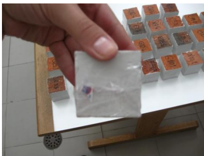
Figura 3.5.1 – Base dos provetes selada com folha de polietileno.
