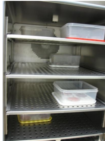
Figura 3.3.3 – Provetes na câmara climática
