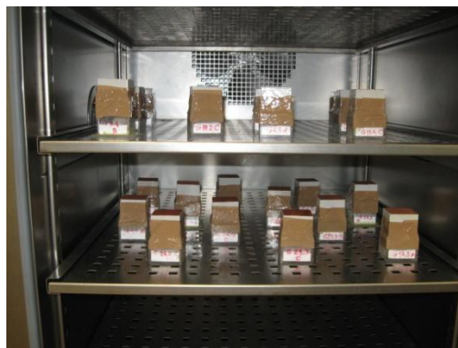
Figura 4.4.2 – Provetes cobertos com fita adesiva no interior da câmara climática
