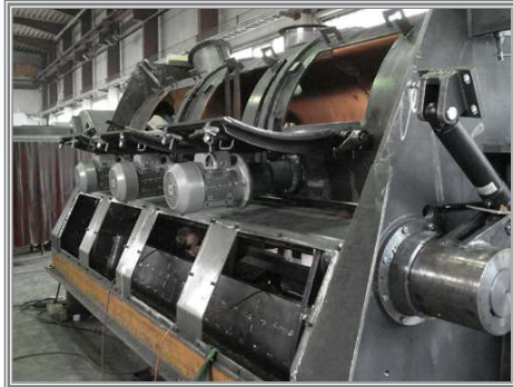
Mélangeur de grande capacité
