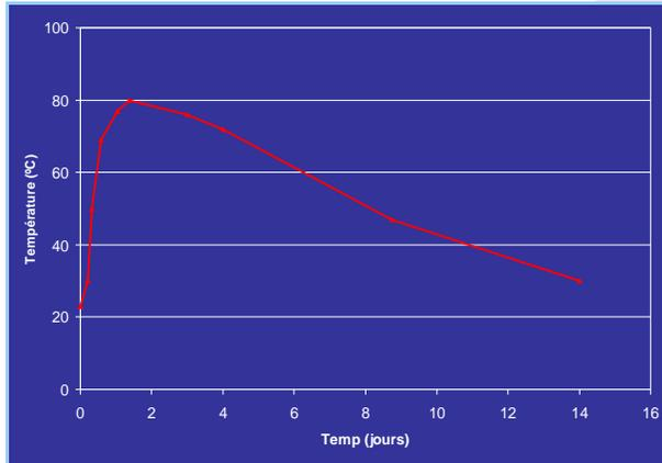
Traitement thermique simulant l'échauffement ayant existé au sein d'une pièce massive en béton (longueur = 14 m, largeur = 3,5 m et hauteur = 1,5 m) à base de CEM I coulée en place avec une température extérieure moyenne de 23°C. Le cycle été calculé par le programme de calcul CESAR-LCPC, module Texo.
