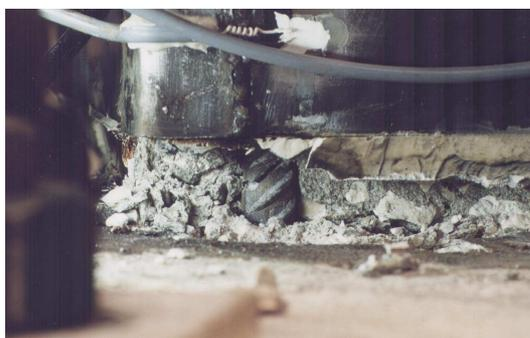
Figura 4 – Pormenor da rotura da armadura longitudinal de canto do modelo P5
