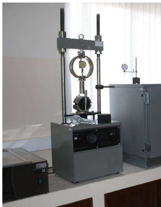
Figura 6 – Equipamento para compactação por impacto e prensa de compressão Marshall
