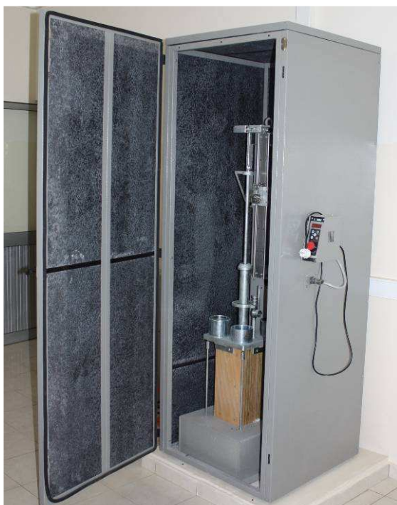
Figura 6 – Equipamento para compactação por impacto e prensa de compressão Marshall
