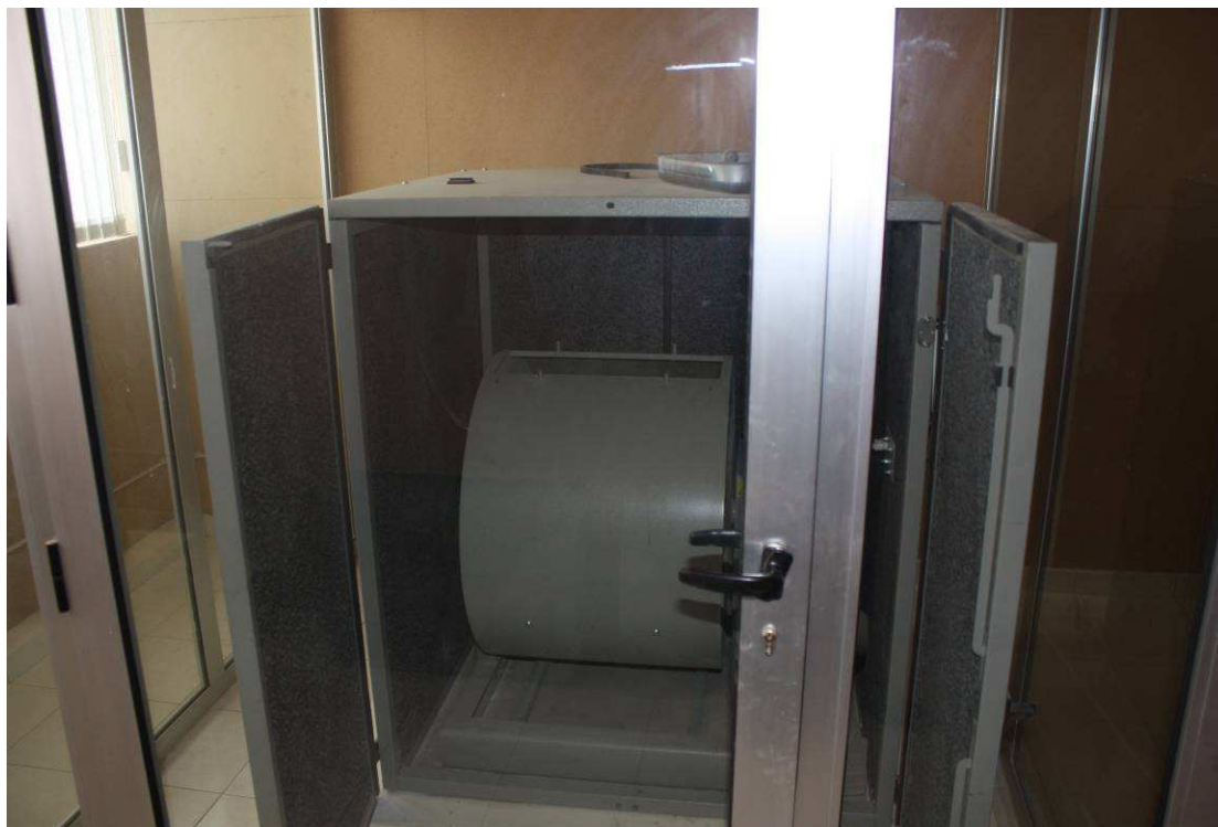
Figura 5 – Equipamento para o ensaio de desgaste de Los Angeles em câmara insonorizada
