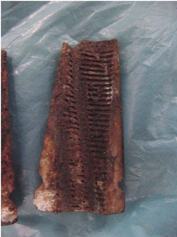
Figura 8 – Fotografia de uma das Clavetes Recuperadas da Cabeça Selada de uma das Ancoragens (Salgado et al. (2007)
