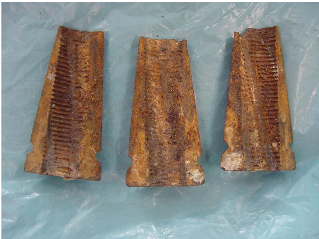
Figura 14 – Fotografia das 3 Clavetes com Sinais de Escorregamento de um dos Cordões da Ancoragem nº 8
