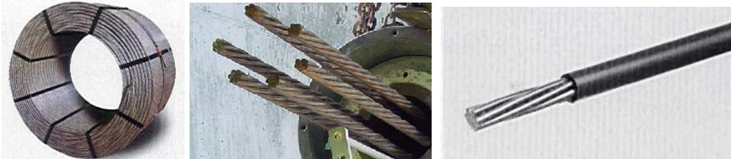
Figura 3 – Exemplo de Cordões de Aço de Pré-esforço
