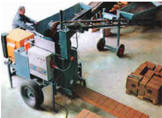
Figura 86 – Fabrico de Blocos de Terra Compactada. (fonte: Alternative Construction)
