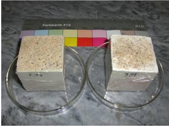
Figura 3.60 - Comparação de um provete de argamassa contaminado com NaCl (à esquerda) e outro com Na 2 SO 4 (à direita), após saída da câmara climática (T=70°C e HR=10%)
