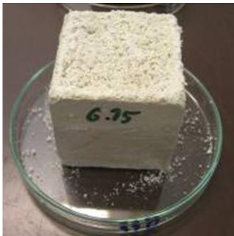
Figura 3.42 - Pormenor de um provete contaminado com \text{Na}_2\text{SO}_4 durante o ensaio de secagem
