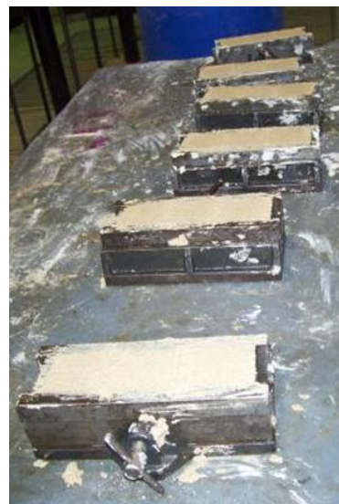
Figura 3.7 – Aspecto final dos provetes antes da desmoldagem
