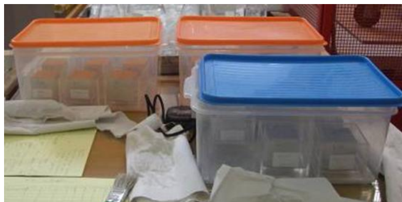
Figura 3.38 – Absorção capilar dos provetes
