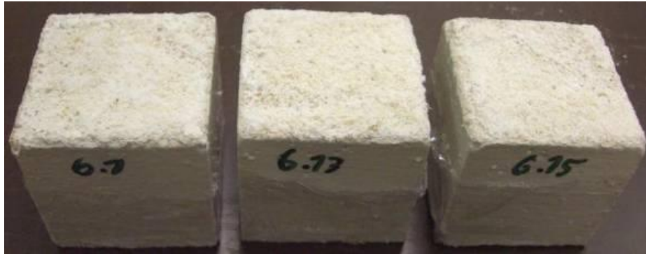
Figura 3.45 - Comparação entre um provete de argamassa contaminado somente com \text{Na}_2\text{SO}_4 (à esquerda), com \text{Na}_2\text{SO}_4 +Ácido Cítrico (ao meio) e com \text{Na}_2\text{SO}_4 +Ácido Fosfocítrico (à direita), no final do ensaio de secagem
