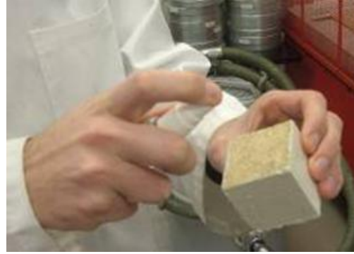
Figura 3.61 - Aplicação por pulverização de um modificador de cristalização num provete de argamassa
