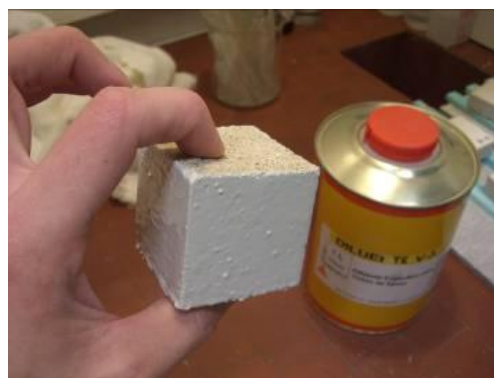
Figura 3.10 – Provete impermeabilizado após 2ª camada
