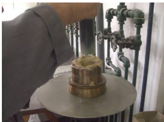
Figura 3.11 – Apiloamento da argamassa
