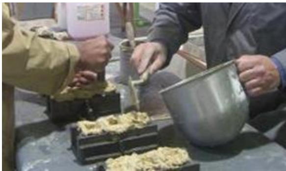
Figura 3.6 – Preenchimento dos moldes com argamassa
