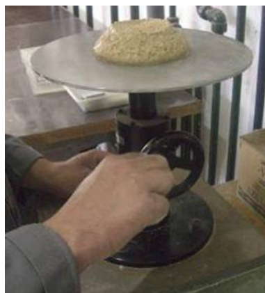
Figura 3.12 – Realização das 15 pancadas na argamassa
