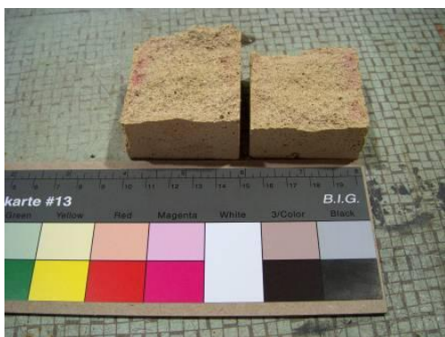
Figura 3.9 – Aspecto de um provete (carbonatado) após o teste com fenolftaleína
