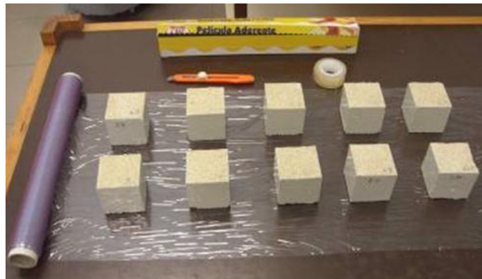
Figura 3.28 – Aplicação da película
