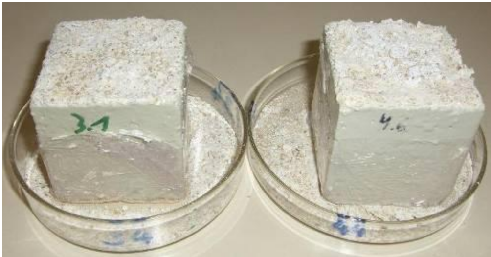
Figura 3.69 - Comparação entre um provete de argamassa contaminado somente com \text{Na}_2\text{SO}_4 (à esquerda) e com \text{Na}_2\text{SO}_4 +Ácido Cítrico (à direita), no final do ensaio de secagem
