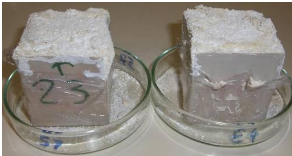
Figura 3.71 - Comparação entre um provete de pedra de Malta contaminado somente com \text{Na}_2\text{SO}_4 (à esquerda) e com \text{Na}_2\text{SO}_4 +Ácido Cítrico (à direita), no final do ensaio de secagem
