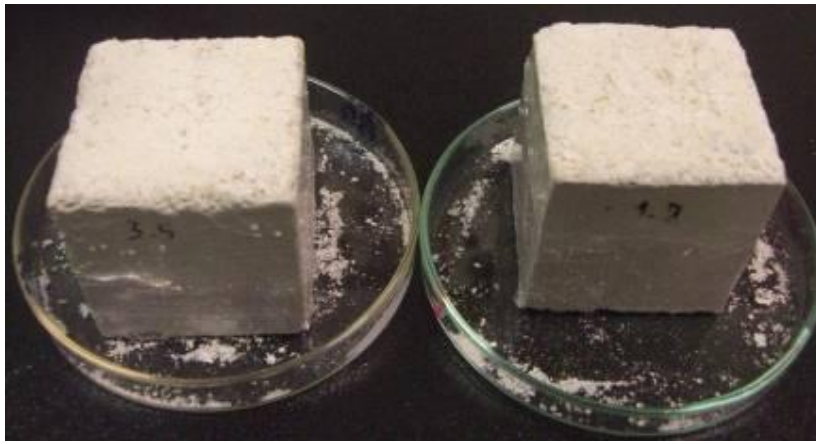
Figura 3.57 - Comparação entre um provete de argamassa contaminado somente com \text{Na}_2\text{SO}_4 (à esquerda) e com \text{Na}_2\text{SO}_4 +Ácido Cítrico (à direita), no final do ensaio de secagem
