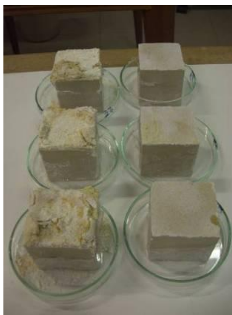
Figura 3.67 - Comparação dos provetes de pedra de Malta contaminados com \text{Na}_2\text{SO}_4 (à esquerda) e com \text{NaCl} (à direita), durante o ensaio de secagem
