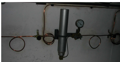
Fig. 2 – Dispositivos aparentes do sistema de carga das células de fluência
