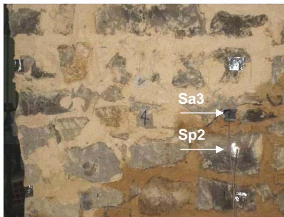
Os valores máximos da humidade relativa registados pelas sondas instaladas em furos nas pedras, no final do período de molhagem, variaram entre 86 e 94%.
