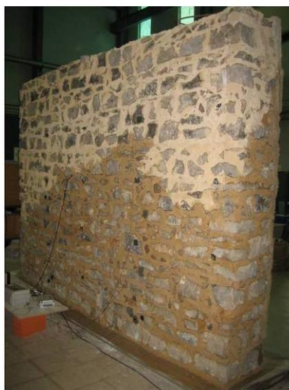
Figura 14 – Aspecto da face não-revestida da parede em estudo após o período de molhagem por aspersão da face oposta
