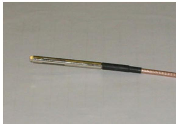
Cada sonda, cujas principais características se indicam no Anexo I, foi colocada num furo horizontal com um diâmetro de cerca de 6 mm e uma profundidade de 50 mm. As paredes do furo foram revestidas com um geotêxtil permeável ao ar e ao vapor de água de modo a proteger o sensor da sonda (Figura 9a). Após a introdução da sonda a respectiva abertura foi selada por colagem de um disco circular de folha de acetato sobre a superfície da parede (Figura 9b).
