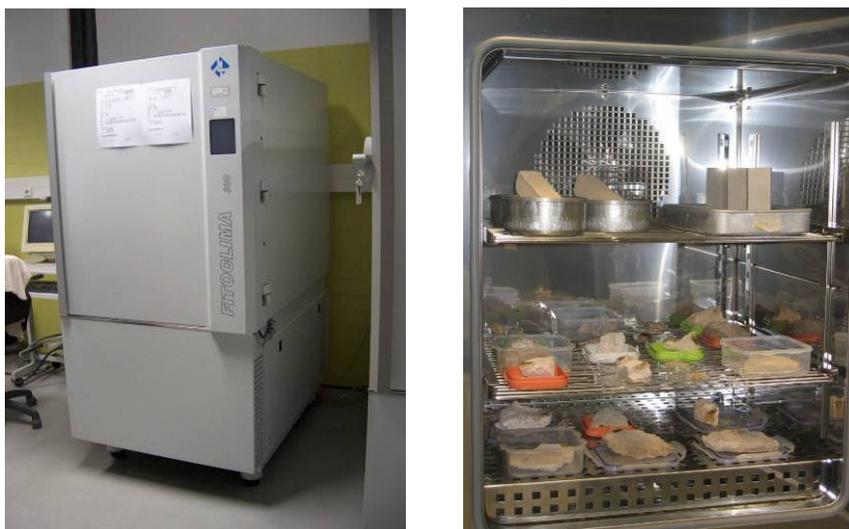
Figura 24 – Câmara climática utilizada para o ensaio higroscópico. Aspecto dos provetes ensaiados
