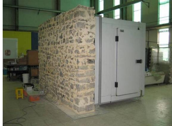
Figura 3 – Câmara higrotérmica durante a fase de aquecimento forçado da parede
