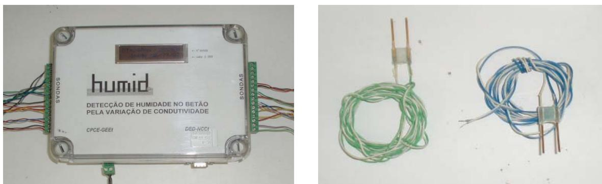
Figura 5 – Humidímetro e sondas
