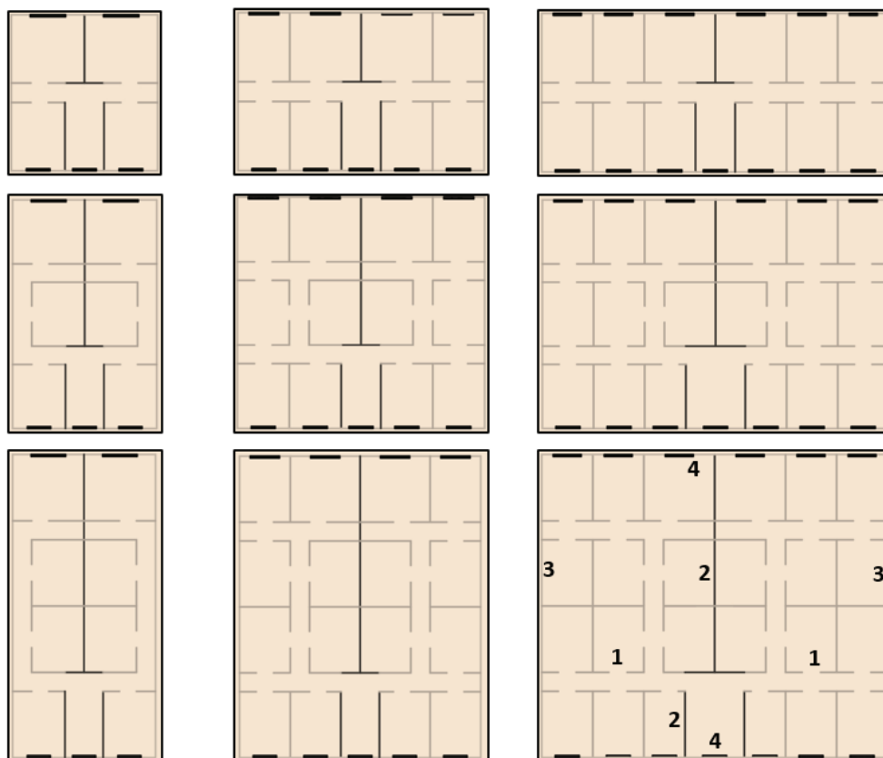
Figura 3 Plantas tipo de edifícios de alvenaria com indicação de vários tipos de parede: 1) paredes interiores divisórias com função resistente ou não; 2) paredes interiores resistentes entre alojamentos e núcleos de escada; 3) paredes de empena; 4) paredes de fachada
