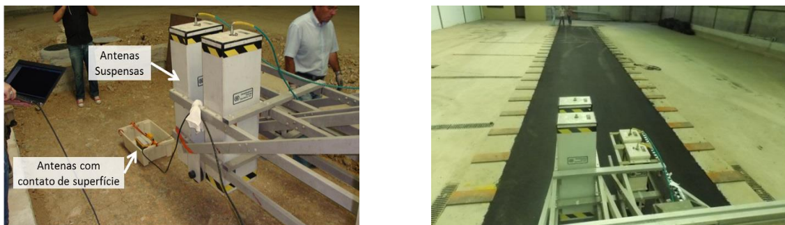
Fig. 3. Sistema de ensaios do radar de prospecção (GPR)
