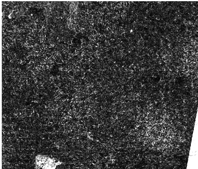
Figura 4 – Imagem de diferenças entre épocas gerada para a fissura do encontro da margem esquerda
